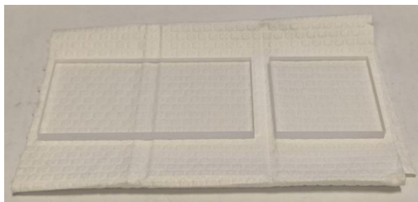
Рисунок 2.2 – Заготовки из кварцевого стекла размерами 100 \times 50 \times 5 мм (слева) и 50 \times 50 \times 5 мм (справа).
