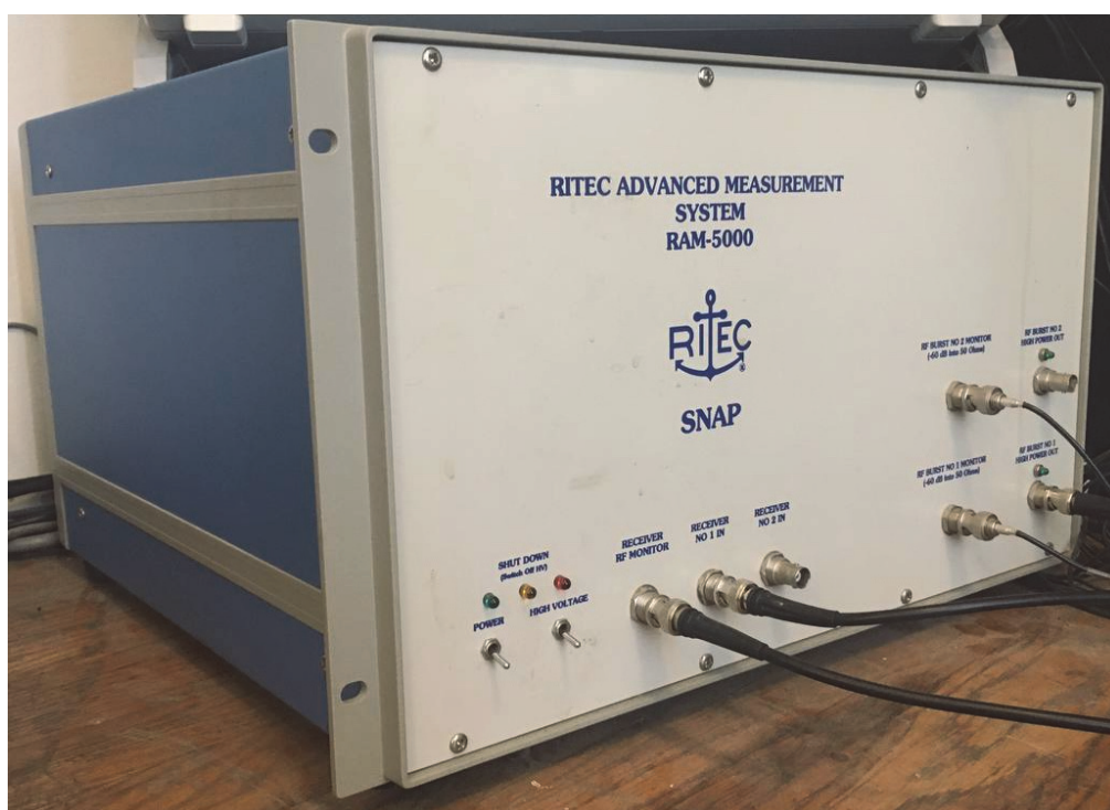
Рисунок 1.2 — Фотография ультразвукового измерительного комплекса RAM-5000 SNAP SYSTEM (Ritec).
