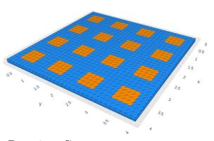
Рис. 8 — Сетка метода конечных элементов на метаповерхности.
