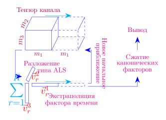
Рис. 7 — Структура алгоритма экстраполяции канала
