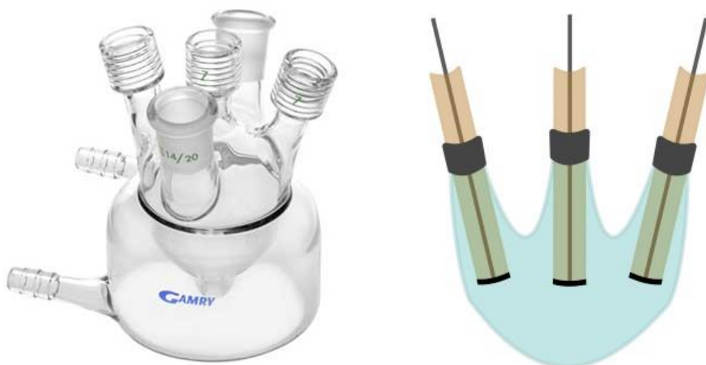
Рисунок 2.2. Фото и схема трехэлектродной ячейки электроосаждения
