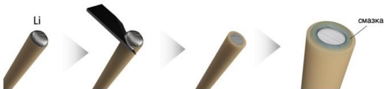
Рисунок 2.1. Схема подготовки литиевого электрода к электроосаждению
