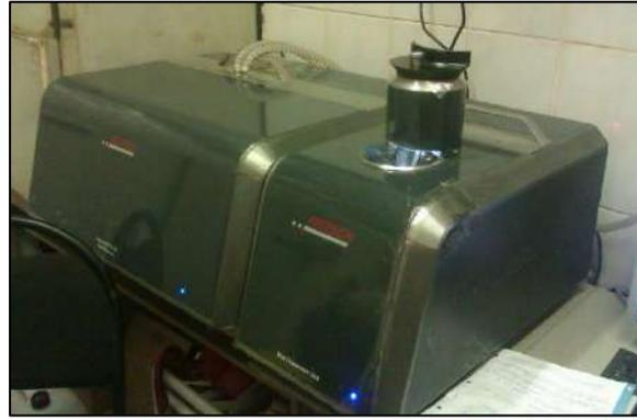
Рис. 3.3.5. Оборудование для гранулометрического анализа. Слева – виброгрохот Fritsch Analysette 3 PRO для сухого отсева, справа – лазерный дифракционный анализатор частиц Fritsch Analysette 22 Comfort (фото автора).
