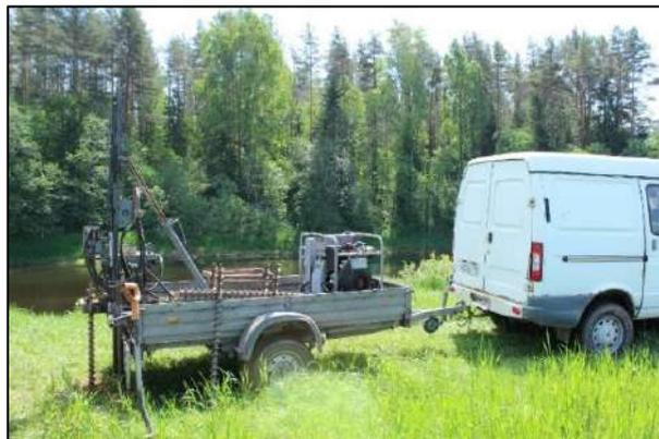
Рис. 3.3.2. Буровая установка УКБ 12/25 (фото Н.С. Назаровой).
