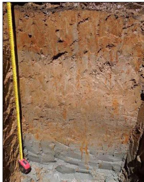
Рис. 4.1.10. Отложения, вскрытые шурфом Ш1 на глубине 1,60 – 2,50 м. На глубине 2,35 м хорошо виден переход к слою сизого цвета, представленного тяжёлыми суглинками и глинами с характерным запахом сероводорода (фото автора).
