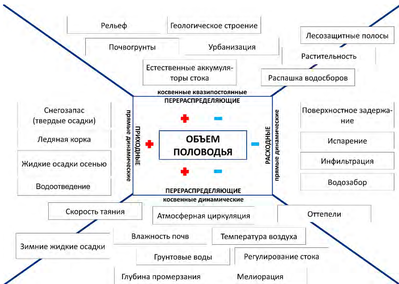
Рисунок 1.3 – Модернизированная классификация факторов формирования стока половодья и их характеристик [Варенцова и др., 2022b]
