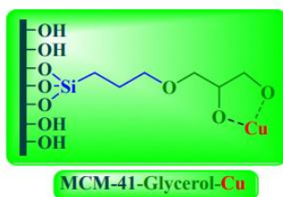
Рисунок 2.15. Схематичное изображение катализатора Cu(II)-глицерин-МСМ-41
