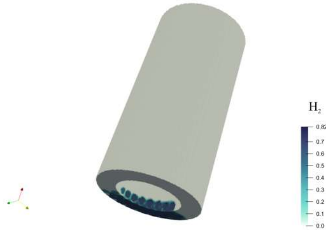
Рисунок 4.2 — Распределение топлива за 10 мкс, непосредственно перед зажиганием. Стехиометрическая смесь.
