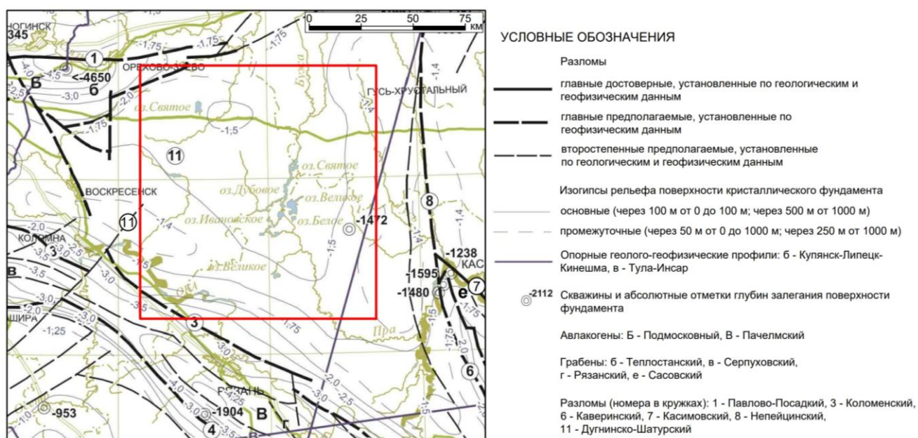
Рисунок 16. Схема строения фундамента района Клепиковского прогиба [41]
