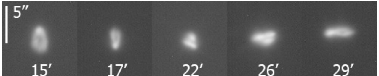
Рисунок 3.1 — Внеосевые изображения звезды, получаемые камерой автогида. Указано так же расстояние от оптической оси.
