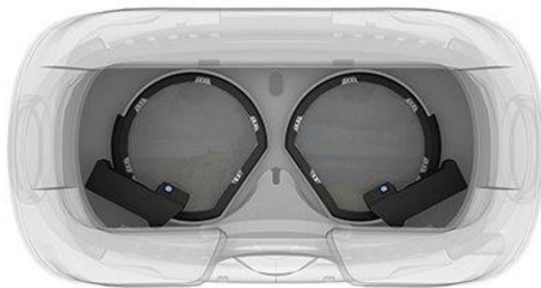
Рисунок 41 - Биноклярное дополнение Pupil Labs Add-on для регистрации движения глаз, совместимое с HTC Vive
