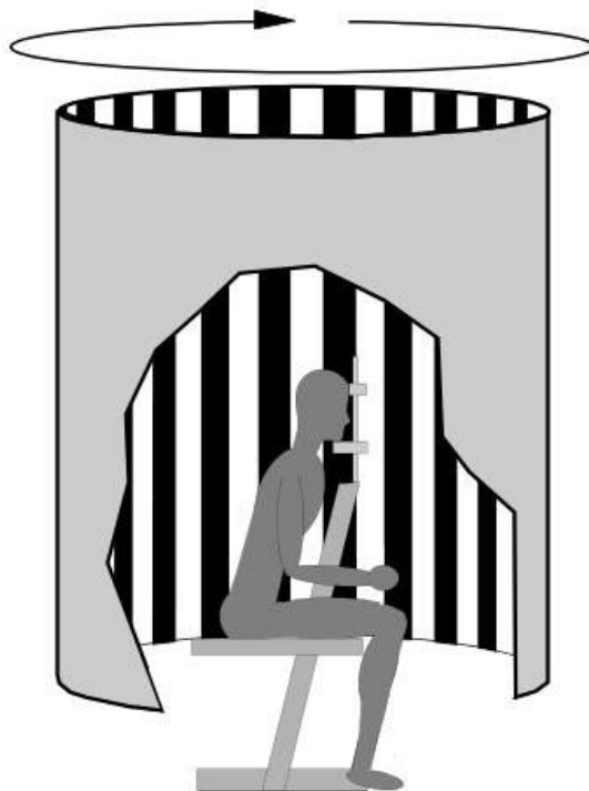
Рисунок 16 - Схема одной из первых экспериментальных установок, которую использовали М. Фишер и А. Корнмюллер при изучении иллюзии движения собственного тела. Человек помещается внутрь полого цилиндра - оптокинетического барабана. Стрелкой показано направление вращения цилиндра вокруг испытуемого (по Schulte-Pelkum, 2013).
