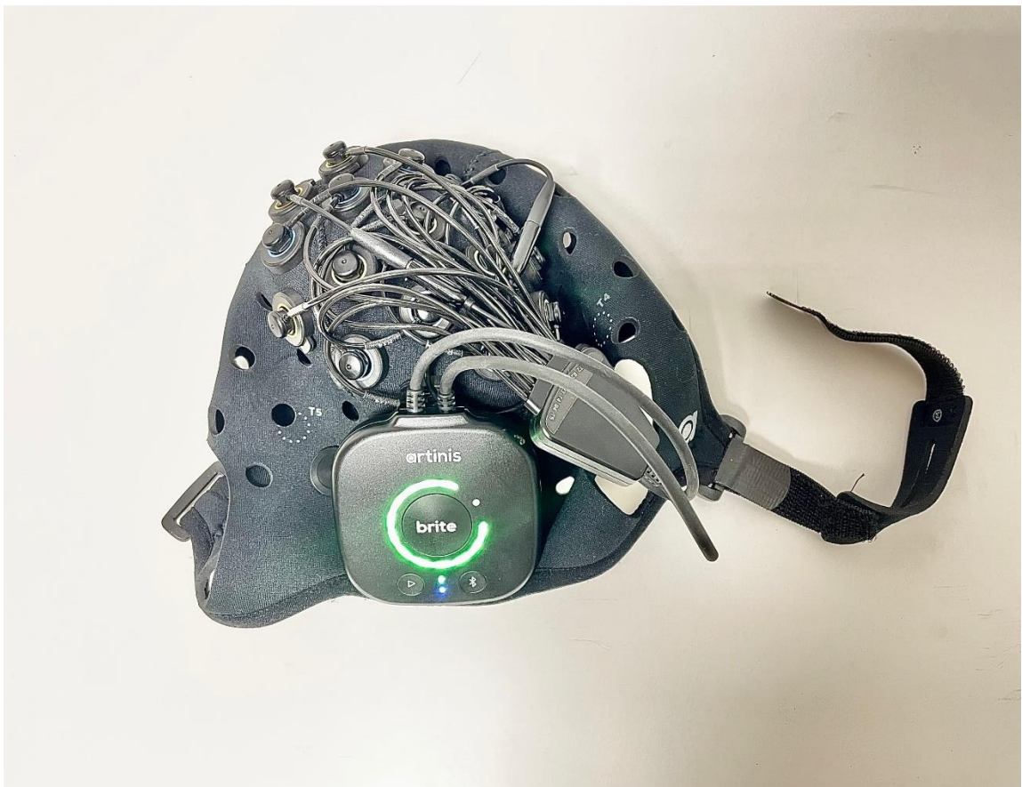
Рисунок 91 - Носимое устройство 27-ch fNIRS Artinis Brite
