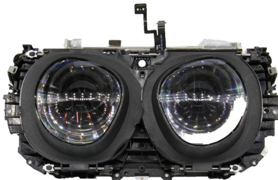
Рисунок 7 - Линзы Френеля для системы VR типа «шлем»
