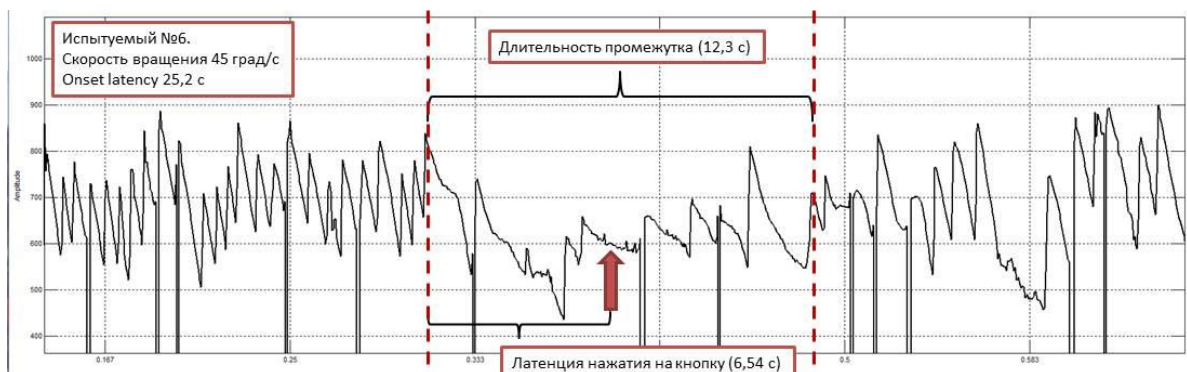
Рисунок 33 - Пример определения значений длительности промежутка увеличения медленных фаз ОКН, а также времени от начала данного промежутка до сигнализации испытуемым о моменте возникновения иллюзии движения собственного тела
