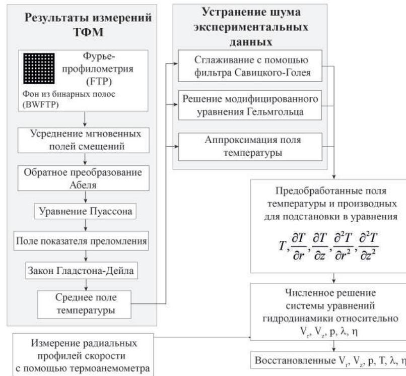
**Рис. 4.2.** Схема восстановления течения с подстановкой экспериментальных данных температуры в уравнения гидродинамики и последующим численным расчетом.
