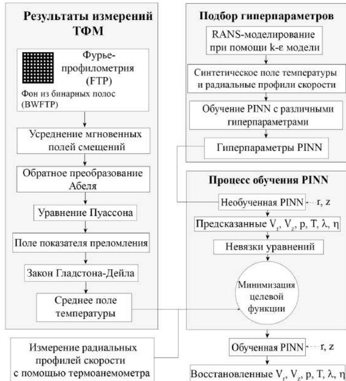
**Рис. 4.5.** Схема восстановления течения с помощью PINN с использованием температурного поля, полученного ТФМ.
