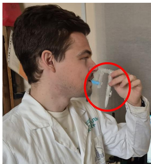
Рисунок 72. а) Схема внутреннего устройства конденсора; б) пример сбора КВА с помощью конденсора без активного охлаждения.
