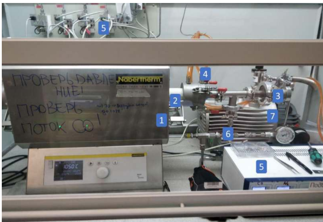
Рисунок 36. Фотография трубчатого реактора синтеза графена (1 – печь, 2 – керамическая труба, 3 – манипулятор, 4 трубки системы охлаждения с жидкостью, 5 – регуляторы расхода газов и блок управления, 6 – клапан для создания повышенного давления, 7 – спиральный насос для откачки системы).
