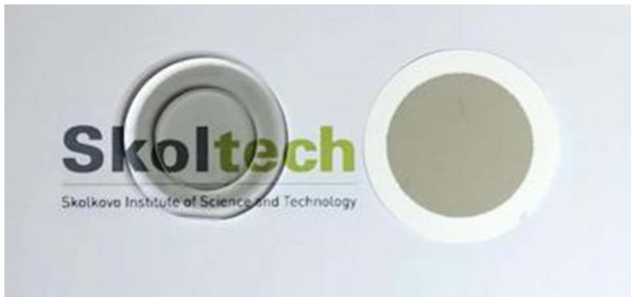
Рисунок 34. Фотография свободностоящей тонкой пленки (слева) и тонкой пленки ОУНТ на фильтре (толщина пленки 60 нм в обоих случаях), полученных методом аэрозольного CVD с искровым разрядом.
