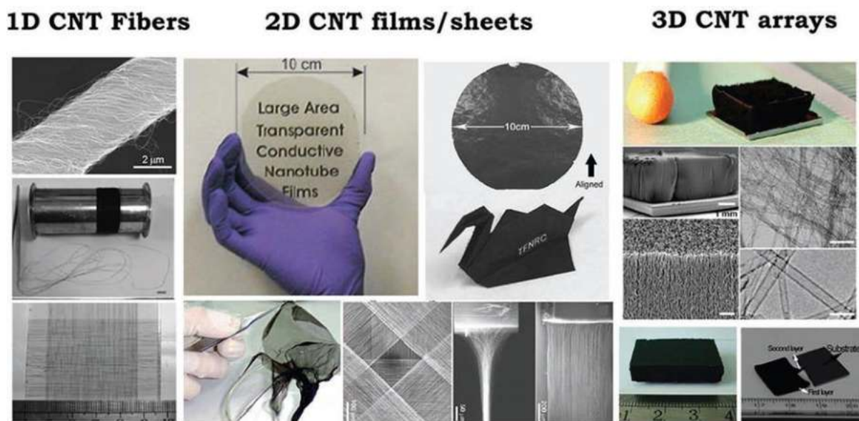
Рисунок 19. Варианты различных продуктов на основе УНТ 1D (нити), 2D (тонкие пленки), а также 3D структуры (леса и аэрогели) с характерными фотографиями [76].
