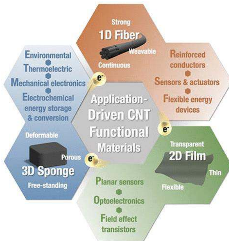
Рисунок 20. Диаграмма, иллюстрирующая 1D, 2D и 3D структуры на основе углеродных нанотрубок с уточнением новых свойств и ключевых приложений [77].
