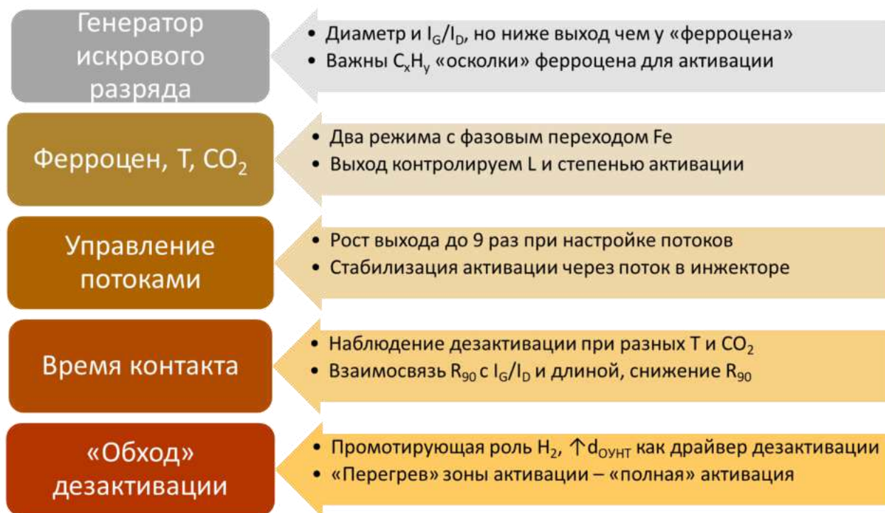
Рисунок 98. Схематичная визуализация развития понимания процесса синтеза однослойных углеродных нанотрубок с помощью реакции Будуара в представленном цикле работ.
