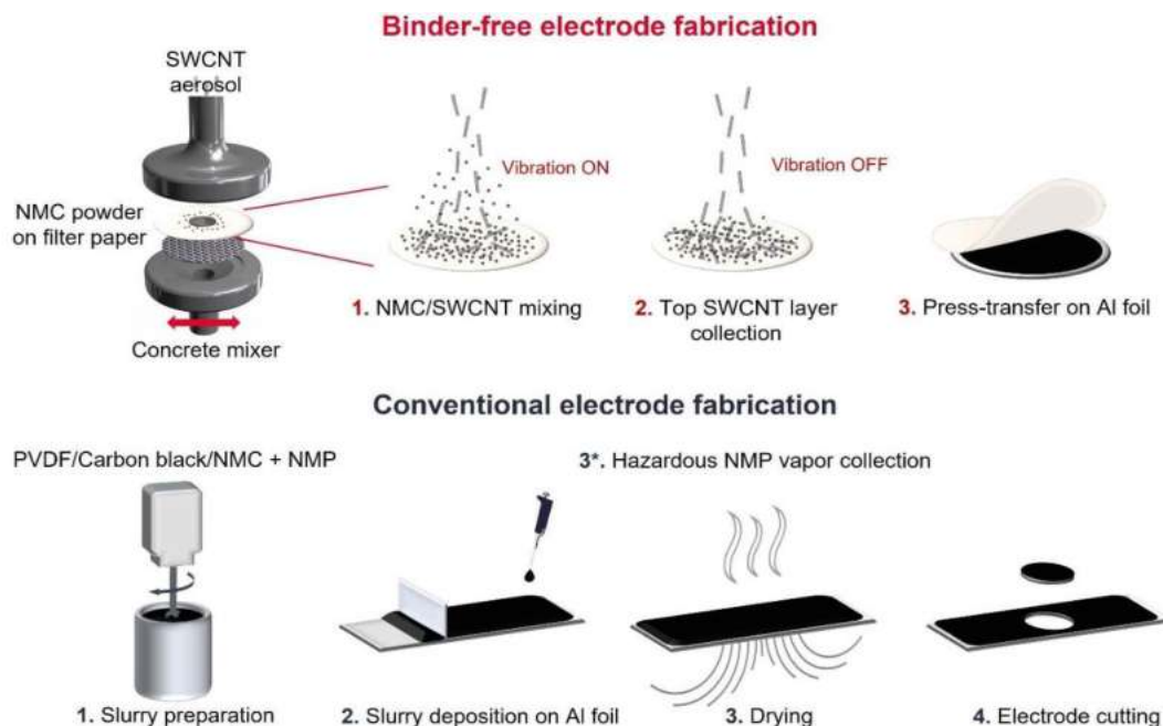
Рисунок 142. Схемы изготовления катодов без связующего (этот раздел), классическим методом.
