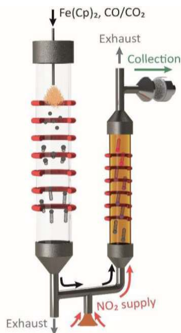
Рисунок 135. Схематичное изображение экспериментальной тандемной установки для синтеза аэрозоля ОУНТ и последующей обработки полученного материала диоксидом азота.
