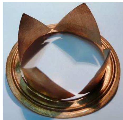
Рис. 2.4. Диафрагмы с насечками до и после раскрытия между КВД и КПД.
