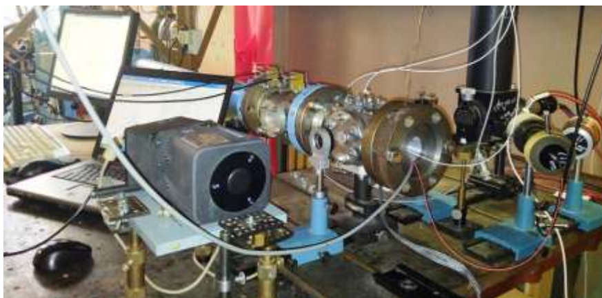
Рис. 4.1. Общий вид установки по измерению времен задержки воспламенения в горючих смесях.
