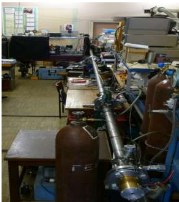
Рис. 2.1. Общий вид ударной трубы DDST-M.
