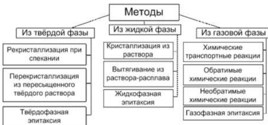
Рисунок 32. Классификация основных методов формирования покрытий.
