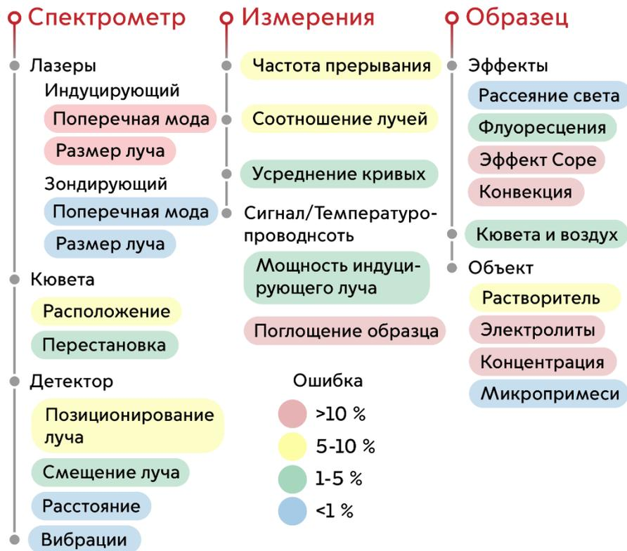
Рис. 27. Влияние источников систематической погрешности фототермических измерений светопоглощения и температуропроводности.
