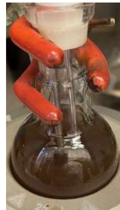
Рисунок 19. Фотография реакционной смеси в конце синтеза атомарно-тонких структур 3 МС CdTe500OA.
