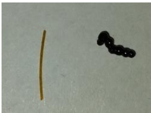
Рисунок 83. Фотография исходного волокна В1 (слева) и после термообработки на воздухе при 225 °С в течение 20 мин (справа).
