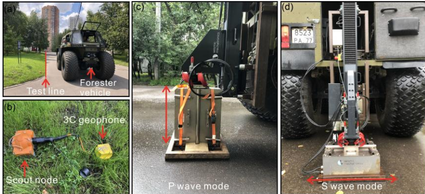
Рис. 16. Расположение опытной линии и используемого оборудования. (a) Трасса опытной линии и транспортное средство с вибрационным источником, (b) беспроводная система SCOUT и трёхкомпонентный сейсмоприёмник, (c) вибрационный источник в режиме возбуждения P-волн, (d) вибрационный источник в режиме возбуждения S-волн.
