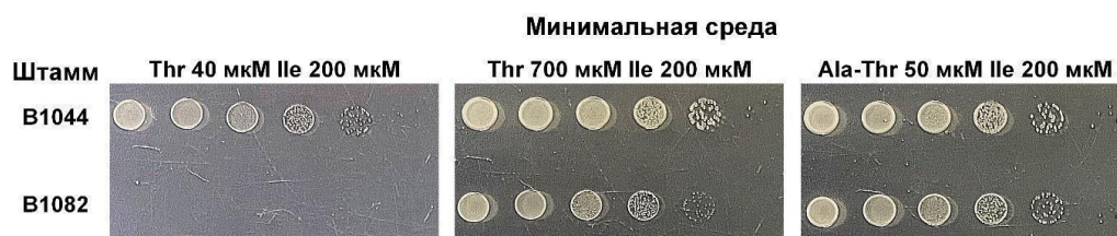
Рисунок 2. Сравнение скорости роста дефектного по синтезу и транспорту треонина B1044 и его мутантного производного B1082 на агаризованной M9 с добавлением L-треонина или L-аланил-L-треонина в качестве источника L-треонина в присутствии изолейцина.
