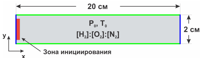
Рисунок 1 — Схема постановки задачи о ячеистой детонации в канале.
