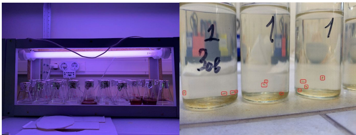
Рисунок 2. Экспоненциальная фаза роста зеленой водоросли Scenedesmus quadricauda в люминостате (а) и пример определения класса опасности грунтов на основе оценки смертности рачков Daphnia Magna (б)
