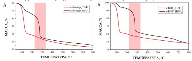
Рисунок 7. Данные термогравиметрического анализа для образцов (A) — а-биочар и (Б) — а-ВОГ, исходных и насыщенных ТБФ (после процесса сорбции в  $0.5M\ HNO_3$ ).
