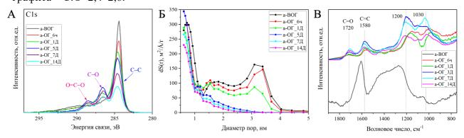
Рисунок 9. Характеризация образцов а-ВОГ после окисления персульфатом аммония в течение различного времени: (A) – C1s РФЭС-спектры, (Б) – распределение пор по размерам, (В) – ИК-спектры.
