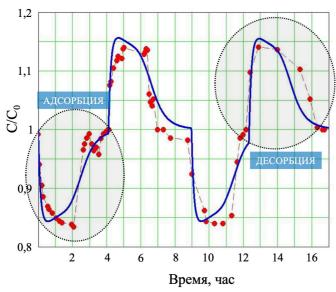
Рисунок 18. Изменение концентрации раствора NaCl, выходящего из рабочей ячейки, при динамическом режиме. Условия эксперимента:  $C_0 = 1 \text{ г/л}$ ; U = 1,2 B; размеры пористых электродов (см):  $3 \times 3 \times 0,5$ ; скорость потока: 0,69 мл/мин; ширина потока раствора -0,2 см. Пунктиром отмечены экспериментально полученные данные, сплошной линией – данные, полученные на основании математической модели.
