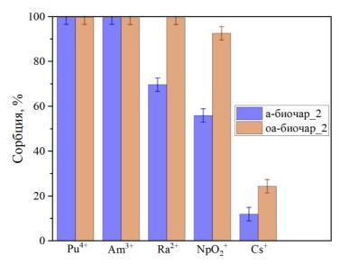
Рисунок 15. Сорбция катионов радионуклидов из модельного раствора, имитирующего природную воду (pH 7,4±0,1; [сорбент] = 0,5 г/л; [Pu<sup>4+</sup>] =  $2 \cdot 10^{-8}$  M;  $[Am^{3+}] = 3 \cdot 10^{-10} \text{ M}; [Ra^{2+}] = 2 \cdot 10^{-8} \text{ M}; \\ [NpO_2^+] = 2 \cdot 10^{-6} \text{ M}; [Cs^+] = 3 \cdot 10^{-10} \text{ M}; \\ NaHCO_3 - 96,0 \text{ мг/л}; CaSO_4 \cdot 2H_2O - 60,0 \text{ мг/л}; MgSO_4 - 60,0 \text{ мг/л}; KCl - 4,0 \text{ мг/л}.$
