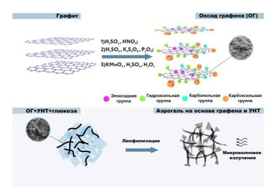
Рисунок 16. Схема получения композитного аэрогеля
