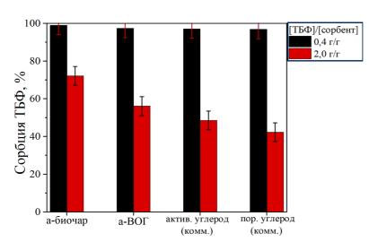
Рисунок 2. Сорбция ТБФ на исследуемых углеродных материалах из 0.5М HNO<sub>3</sub> при различных соотношениях ТБФ/углеродный материал ([сорбент]=0.2 г/л).
