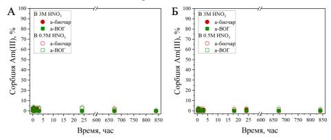
Рисунок 6. Кинетика сорбции Am(III) (A) – при отсутствии и (Б) – в присутствии ТБФ из 0,5 и 3M HNO<sub>3</sub> на а-ВОГ и а-биочар ([сорбент] = 0,2 г/л; [ТБФ] = 0,1 г/л; [Am(III)] =  $3 \cdot 10^{-10}$  M).
