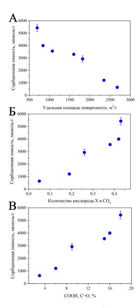
Рисунок 11. Зависимость сорбционной емкости образцов а-ОГ по U(VI) от (A) — значения удельной площади поверхности; (Б) — степени окисленности (X в формуле CO<sub>x</sub>, рассчитанной с использованием отношения C:О, полученного из данных РФЭС); (В) — от вклада карбонильных и карбоксильных групп в РФЭС-спектре.
