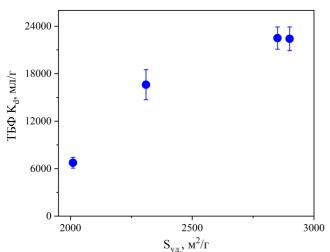
Рисунок 4. Зависимость коэффициентов распределения ТБФ на углеродных материалах в 0,5М HNO<sub>3</sub> от удельной площади поверхности.
