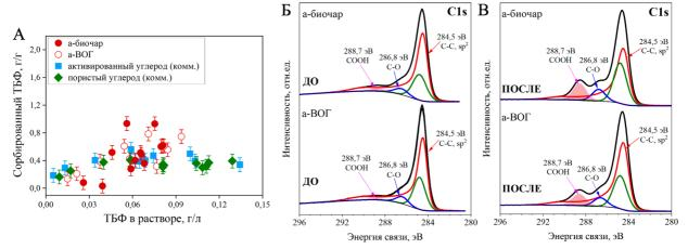
Рисунок 5. (A) Сорбция ТБФ на углеродных материалах из 3M HNO<sub>3</sub>; C1s РФЭС-спектры образцов а-биочар и а-ВОГ (Б) – до и (В) – после эксперимента.
