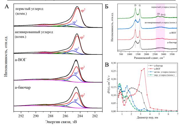
Рисунок 1. Характеризация синтезированных материалов: (A) — C1s РФЭС-спектры; (Б) — Рамановская спектроскопия, (В) — распределение пор по размерам.
