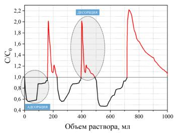
Рисунок 19. Три последовательных цикла электросорбции-десорбции ЕМД на мезопористых углеродных электродах. Условия эксперимента:  $C_0 = 1 \text{ г/л}$ ; U = 1,2 B; размеры электродов (см):  $12 \times 3 \times 0,5$ ; зазор между электродами -0,3 см; скорость потока -0,75 см<sup>3</sup>/мин.
