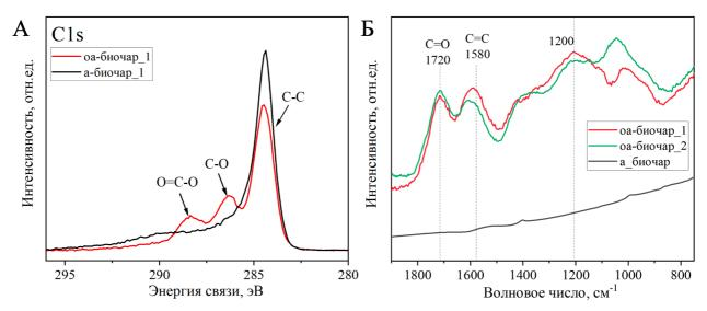
Рисунок 12. Характеризация образцов оа-биочар: (A) — C1s РФЭС-спектры, (Б) — ИК-спектры.
