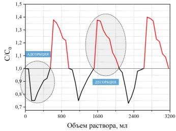
Рисунок 20. Три последовательных цикла электросорбции-десорбции ЕМД на мезопористых углеродных электродах. Начальные условия эксперимента:  $C_0 = 1 \text{ г/л}$ ; U = 1,2 B; размеры электродов (см):  $12 \times 3 \times 0,2$ ; зазор между электродами: 0,3 см; скорость потока: 1,15 мл/мин
