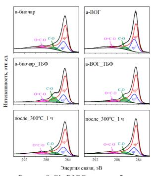
Рисунок 8. C1s РФЭС-спектры образцов а-ВОГ и а-биочар в начальный момент, после сорбции и после температурной обработки при 300°С в течение 1 часа.
