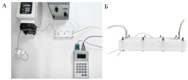
Рисунок 17. (A) – фото лабораторной установки для емкостной деионизации воды и (Б) – электрохимической ячейки.
