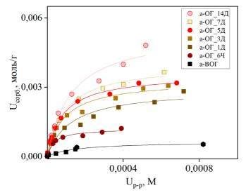
Рисунок 10. Изотермы сорбции U(VI) на образцах а-ОГ. Линией показано моделирование изотерм уравнением Ленгмюра.
