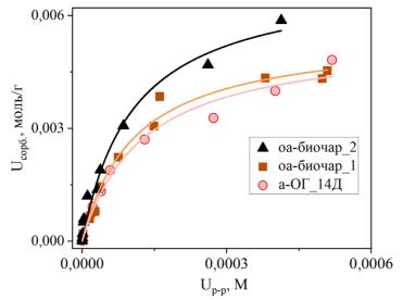
Рисунок 13. Изотермы сорбции U(VI) на образцах оабиочар в сравнении с а- $O\Gamma_1$ 4д. Линией представлено описание с использование уравнения изотермы Ленгмюра.
