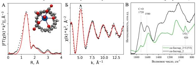
Рисунок 14. Физико-химические формы U(VI) на поверхности оа-биочар\_2: EXAFS-спектр на  $L_3$ -крае урана (A) — амплитуда преобразования Фурье, на врезке предполагаемая конфигурация локального окружения урана, (Б) — исходный спектр в k-пространстве (черные точки — эксперимент, красная линия — результаты моделирования спектра); (В) — ИК-спектры образца до и после сорбции U(VI).
