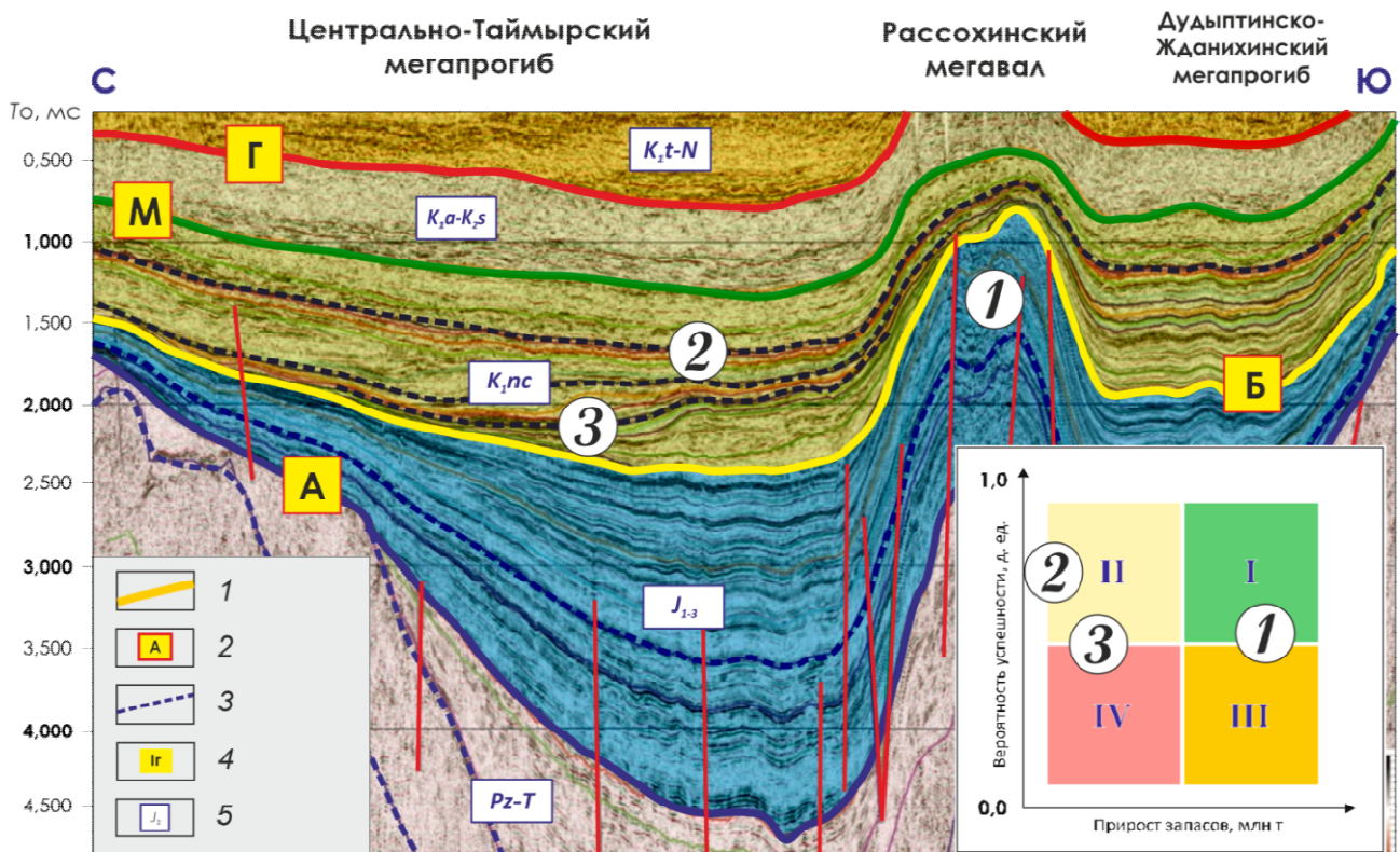
Рисунок 11. Рассохинский мегавал — умеренный риск геологоразведочных работ и высокий ресурсный потенциал. Условные обозначения: 1 — опорные отражающие горизонты (ОГ); 2 — индексы опорных ОГ; 3 — вспомогательные ОГ; 4 — индексы вспомогательных ОГ; 5 — индексы стратиграфических подразделений
