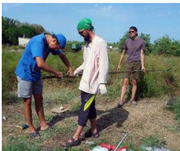
Рисунок 27. Отбор керна скважины DM-1 (Дамчикский участок Астраханского заповедника). Фото автора и Р.Р. Макшаева.
