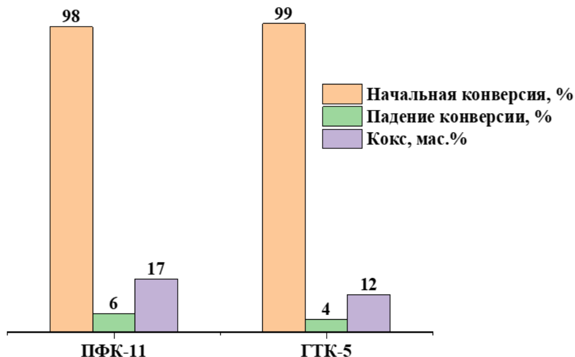
Рисунок 3.36 – Характеристики работы катализаторов на основе цеолитов MEL, полученных разными способами в процессе олигомеризации бутан-бутиленовой фракции в условиях ускоренной дезактивации.
