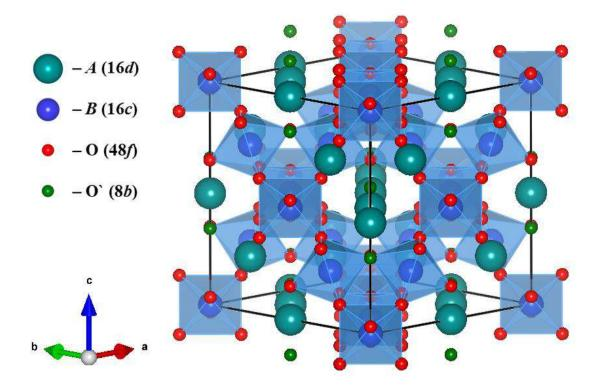
Рисунок 1. Кристаллическая структура фазы пирохлора, соответствующая идеальной модели  $A(16d)_2B(16c)_2O(48f)_6O`(8b)$ . В скобках указаны позиции Вайкоффа соответствующих атомов. Визуализация структуры выполнена в программном комплексе VESTA 3.
