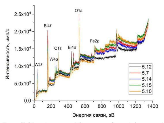
Рисунок 54. Обзорный рентгеновский фотоэлектронный спектр (образцы серии V).
