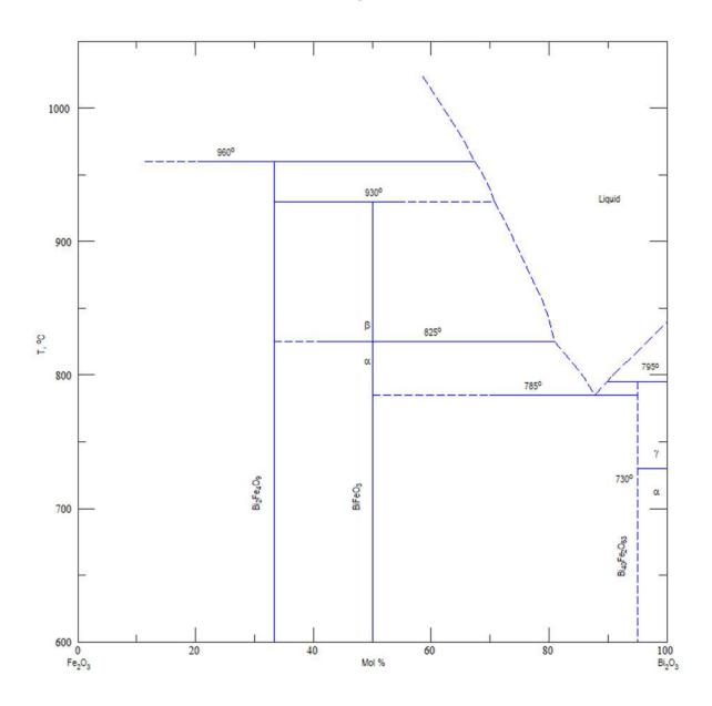
Рисунок 5. Фазовая диаграмма системы Bi<sub>2</sub>O<sub>3</sub> – Fe<sub>2</sub>O<sub>3</sub> по данным работы [174].
