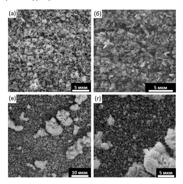
Рисунок 46. Микрофотографии образцов 5.43 и 5.40 серии V, отличающихся химическим составом и содержащих, кроме фазы пирохлора, фазу  ${\rm Bi}_2{\rm WO}_6$  (а (режим фазового контраста), б – образец 5.43; в (режим фазового контраста), г – образец 5.40).
