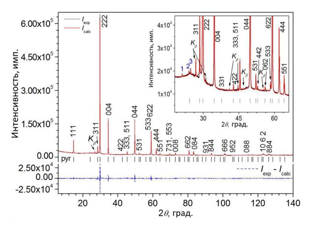
Рисунок 42. Финальные графические результаты Ритвельдовской подгонки симулированной дифрактограммы к экспериментальной (Cu- $K_{\alpha}$  излучение) методом Ритвельда для образца 5.15. На рисунке индексами Миллера (hkl) обозначены избранные рефлексы фазы пирохлора. На вставке к рисунку показана дифрактограмма в диапазоне  $2\theta = 18^{\circ} - 66^{\circ}$  в увеличенном масштабе (цифрами 1, 2, 3 обозначены три неидентифицированных рефлекса очень малой интенсивности).
