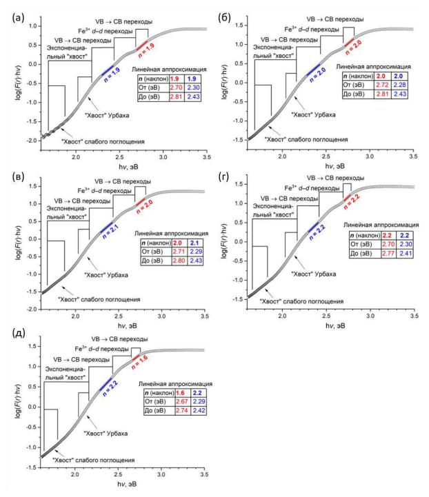
Рисунок 61. Графическое определение показателя степени (n) в уравнении Тауца по данным спектроскопии диффузного отражения в соответствии с методикой, предложенной в [236] (образцы серии V: а (5.12), б (5.7), в (5.14), г (5.15), д (5.10)).
