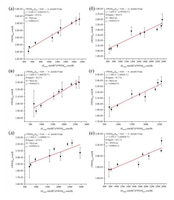
Рисунок 20. Графики «Вильямсона-Холла» для образцов серии II, полученных при различных температурах синтеза (а (90 °C), б (110 °C), в (130 °C), г (150 °C), д (170 °C), е (190 °C)).
