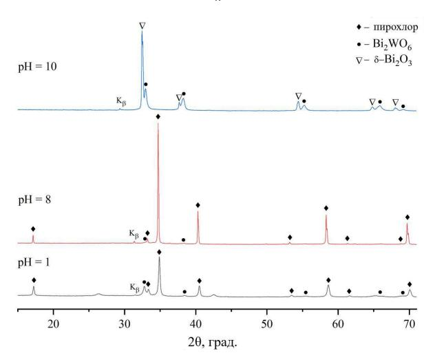
Рисунок 10. Рентгеновские дифрактограммы (Со- $K_{\alpha}$  излучение) образцов серии I, полученных при значениях рH = 1, 8 и 10.
