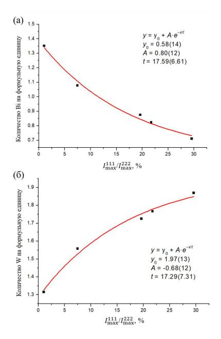
Рисунок 48. Калибровочные кривые, отражающие зависимости (а) количества висмута (z) и (б) количества вольфрама (y) на формульную единицу соединений со структурой пирохлора ( $\text{Bi}_z\square_{2-z}$ )( $\text{Fe}_{2-y}\text{W}_y$ )O<sub>6</sub>O $^{\circ}_{\delta}$ ) от соотношения  $I_{\text{max}}^{111}/I_{\text{max}}^{222}$  (по данным образцов 5.12, 5.7, 5.14, 5.15 и 5.10, Таблица 18).
