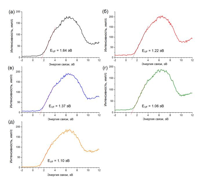
Рисунок 57. Графическое определение положения максимума валентной зоны относительно уровня Ферми ( $E_{VF}$ ) по данным рентгеновской фотоэлектронной спектроскопии в области валентной зоны (образцы серии V: а (5.12), б (5.7), в (5.14), г (5.15), д (5.10)).
