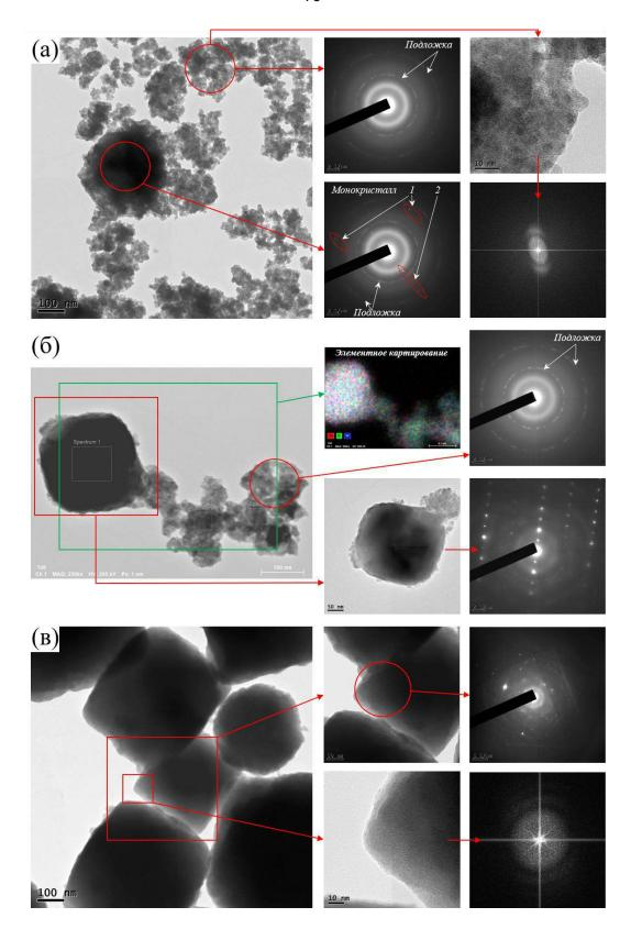
Рисунок 26. Данные по просвечивающей электронной микроскопии образцов серии III, синтезированных при различной продолжительности изотермической выдержки ( $\tau$ ) (1 (a), 30 (б) сек и 5 (в) мин).
