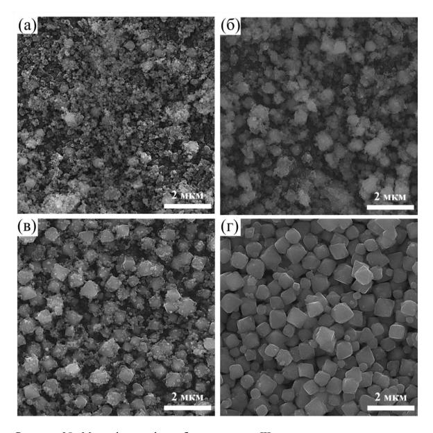
Рисунок 25. Микрофотографии образцов серии III, синтезированных при различной продолжительности изотермической выдержки ( $\tau$ ) (1 (a), 30 (б) сек и 1 (в), 5 (г) мин).
