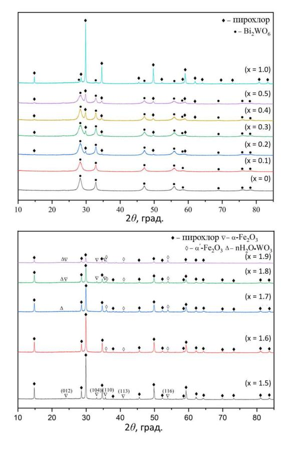
Рисунок 8. Порошковые рентгеновские дифрактограммы (Cu- $K_{\alpha}$  излучение) образцов, полученных в работе [165]. Номинальный состав задаётся формулой:  $Bi_{2-x}Fe_xWO_6$  (где 0 < x < 1.9).
