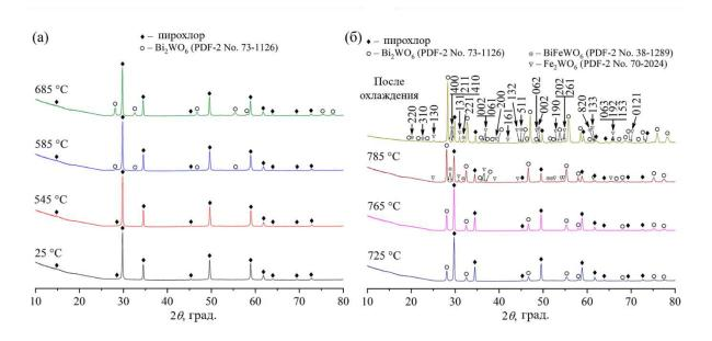
Рисунок 51. Порошковые рентгеновские дифрактограммы (Cu- $K_{\alpha}$  излучение) образца 5.10, измеренные *in situ* при различных температурах нагрева: (a) от 25 °C до 685 °C; (б) от 725 °C до 785 °C.
