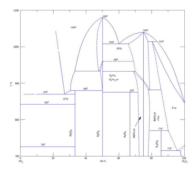
Рисунок 3. Фазовая диаграмма системы Bi<sub>2</sub>O<sub>3</sub> – WO<sub>3</sub> по данным работы [172].
