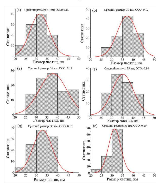
Рисунок 17. Гистограммы и соответствующие функции объёмного нормального распределения частиц, располагающихся в поверхностном слое агрегатов (более крупных частиц), по размерам и параметры нормального распределения: средний размер и ОСО (относительное стандартное отклонение), для образцов серии I, полученных при различных значениях рН суспензии аморфного предшественника (рН = 2 (a), 3 (б), 4 (в), 5 (г), 6 (д) и 7 (е)).
