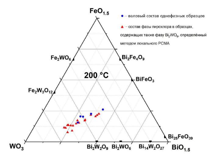
Рисунок 47. Отображение составов соединений со структурой пирохлора, определённых методом рентгеноспектрального микроанализа (PCMA), на концентрационном треугольнике системы  $Bi_2O_3 - Fe_2O_3 - WO_3$ . Образцы 5.12, 5.7, 5.14, 5.15, 5.10: синие круги (валовый состав однофазных образцов); образцы 5.19, 5.23, 5.27 – 5.31, 5.35 – 5.40, 5.43 – 5.45, 5.49: красные треугольники (состав частиц фазы пирохлора в образцах, содержащих также заметные количества фазы  $Bi_2WO_6$ )).
