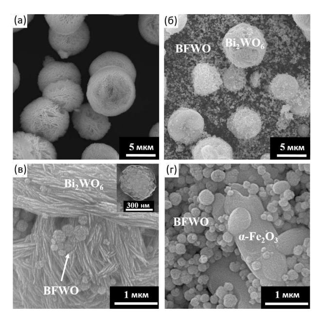
Рисунок 9. Микрофотографии образцов, полученных в работе [165] (номинальный состав: (а) - Bi<sub>2</sub>WO<sub>6</sub>; (б, в) - Bi<sub>1.5</sub>Fe<sub>0.5</sub>WO<sub>6</sub>; (г) - Bi<sub>0.5</sub>Fe<sub>1.5</sub>WO<sub>6</sub>). Аббревиатура BFWO относится к пирохлору.
