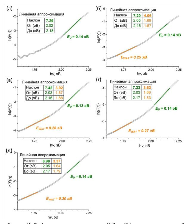
Рисунок 62. Графическое определение энергии Урбаха ( $E_{\rm U}$ ) и энергии «хвоста» слабого поглощения ( $E_{\rm WAT}$ ) по данным спектроскопии диффузного отражения (образцы серии V: а (5.12), б (5.7), в (5.14), г (5.15), д (5.10)).
