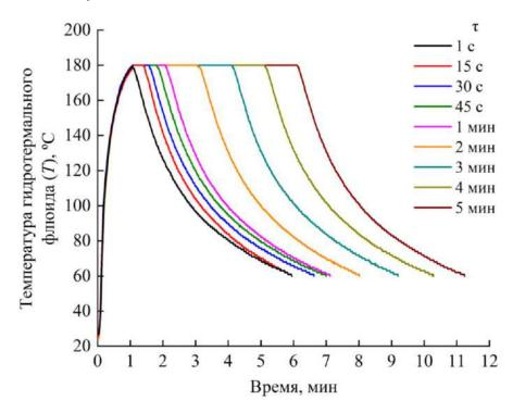
Рисунок 6. Кривые зависимости температуры реакционной среды от времени при гидротермально-микроволновой обработке (τ – продолжительность изотермической (180 °C) выдержки).
