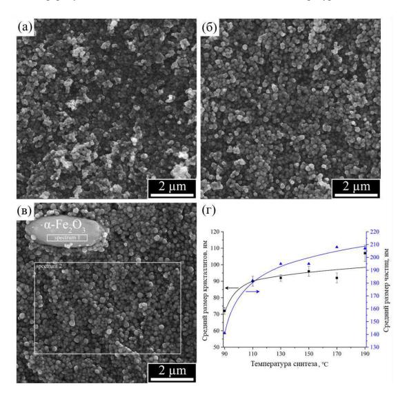
Рисунок 21. (а (90 °C), б (110 °C), в (190 °C)) Микрофотографии образцов серии II и (г) зависимости средних размеров частиц и кристаллитов (метод «Вильямсона-Холла») соединений со структурой пирохлора от температуры синтеза.
