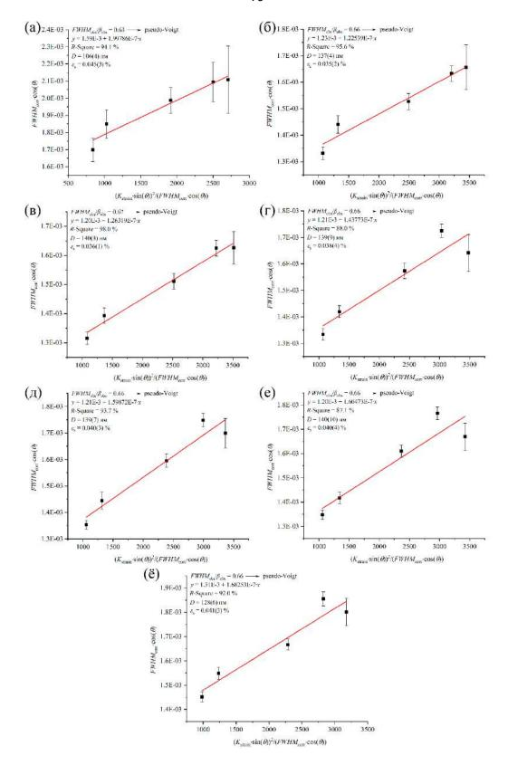
Рисунок 30. (капельное смешение) Графики «Вильямсона-Холла» для образцов серии IV, синтезированных при различной продолжительности изотермической выдержки ( $\tau$ ) (0.5 (a), 1 (б), 1.5 (в), 2 (г), 3 (д), 6 (е), 24 (ё) ч). Тип профиля рефлексов фазы пирохлора псевдо-Фойгтовский (pseudo-Voigt).
