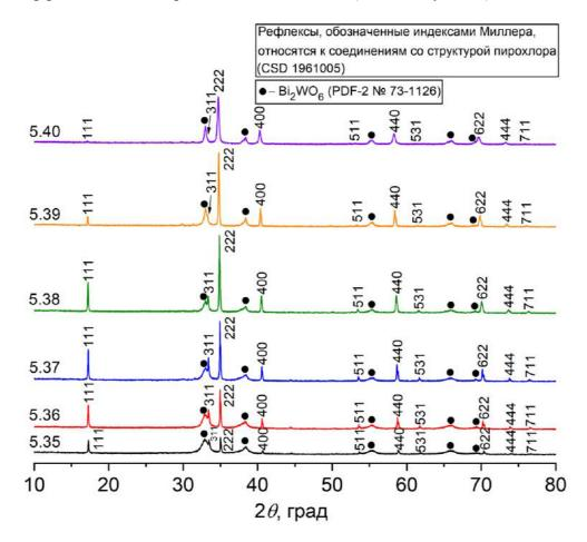
Рисунок 44. Рентгеновские дифрактограммы (Co-*K*<sub>α</sub> излучение) образцов 5.35 – 5.40 серии V, отличающихся химическим составом и содержащих, кроме фазы пирохлора (избранные рефлексы отмечены индексами Миллера), заметные количества фазы Bi<sub>2</sub>WO<sub>6</sub> (PDF-2 № 73-1126).
