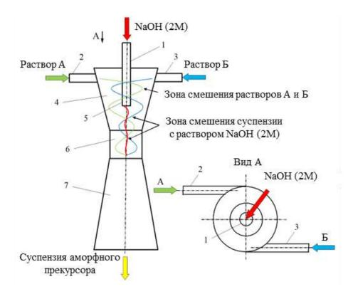
Рисунок 7. Схема синтеза в микрореакторе «микро-BCA-1» и геометрия аппарата: 1 – осевой патрубок; 2,3 – тангенциальные патрубки; 4 – конфузор; 5 – сопло; 6 – горловина; 7 – диффузор.
