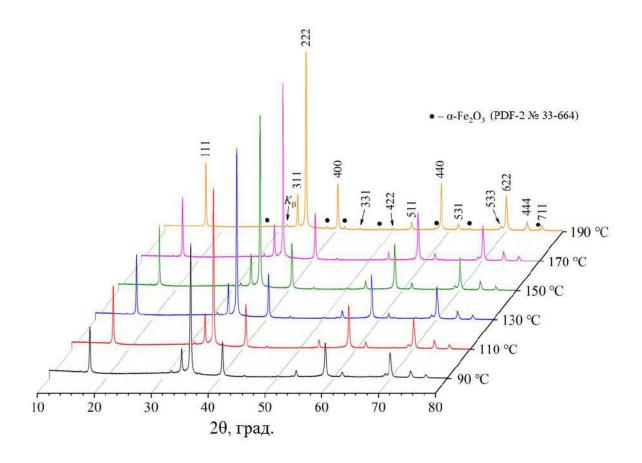
Рисунок 18. Рентгеновские дифрактограммы (Со- $K_{\alpha}$  излучение) образцов серии II, полученных при различных температурах синтеза (все обозначенные индексами Миллера рефлексы принадлежат соединениям со структурой пирохлора).
