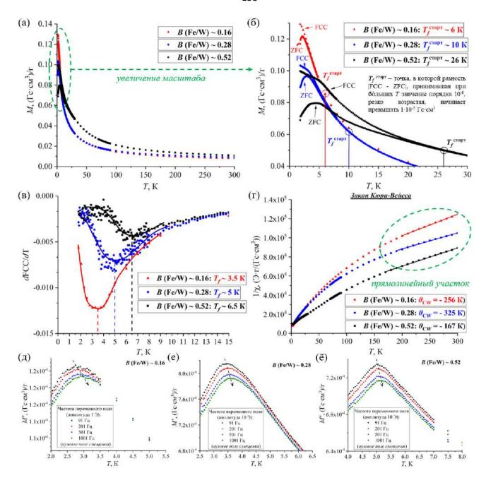
Рисунок 65. (а) Зависимость DC-намагниченности (в режимах FCC и ZFC) от температуры (M(T)) в поле 1 кЭ и (б) то же самое, но в увеличенном масштабе; (в) производная кривой FCC по температуре (dFCC/dT); (г) построение в координатах закона Кюри-Вейсса  $-1/\chi = f(T)$ ; (д-ё) температурные зависимости действительной части AC-намагниченности (M'(T)), полученные для различных частот в нулевом поле смещения. Атомные соотношения Fe/W взяты из Таблицы 18 (однофазные образцы серии V).
