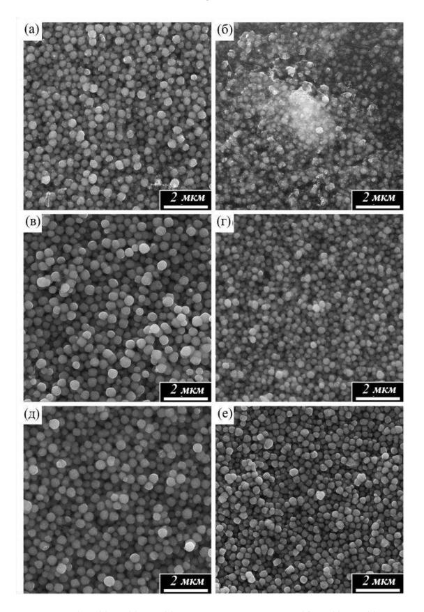
Рисунок 31. (0.5 (а), 1 (в), 24 (д) ч – микрореактор и 0.5 (б), 1 (г), 24 (е) – капельное смешение) Микрофотографии образцов серии IV, синтезированных при различной продолжительности изотермической выдержки  $(\tau)$ .
