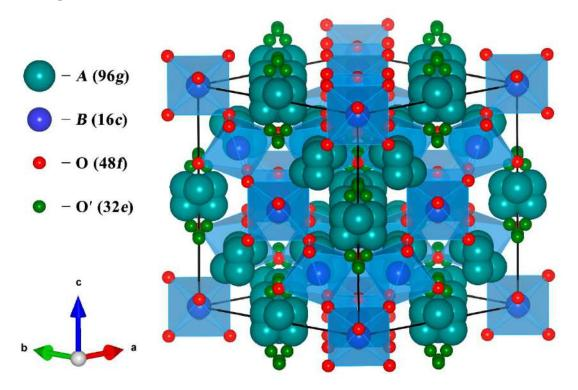
Рисунок 2. Кристаллическая структура фазы пирохлора, соответствующая модели, учитывающей смещение катионов металлов на позиции A и анионов кислорода на позиции O из частных кристаллографических позиций Вайкоффа в общие (A:  $16d \rightarrow 96g$  и O:  $8b \rightarrow 32e$ ). Визуализация структуры выполнена в программном комплексе VESTA 3.
