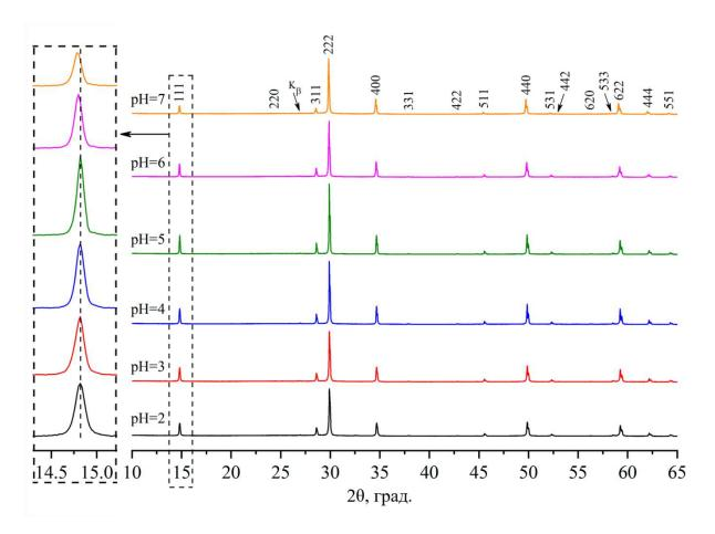
Рисунок 11. Рентгеновские дифрактограммы (Си- $K_{\alpha}$  излучение) образцов серии I, полученных при значениях рH = 2, 3, 4, 5, 6 и 7 (все обозначенные индексами Миллера рефлексы принадлежат соединениям со структурой пирохлора).
