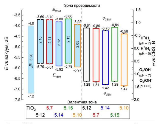
Рисунок 64. Диаграммы энергетических зон синтезированных соединений со структурой пирохлора, построенные в двух шкалах: (левая ось ординат) энергетической – шкала абсолютной энергии и (правая ось ординат) потенциальной – водородная шкала (образцы серии V).
