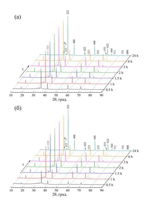
Рисунок 27. (а – микрореактор, б – капельное смешение) Рентгеновские дифрактограммы (Со- $K_{\alpha}$  излучение) образцов серии IV, синтезированных при различной продолжительности изотермической выдержки ( $\tau$ ) (все обозначенные индексами Миллера рефлексы принадлежат соединениям со структурой пирохлора).
