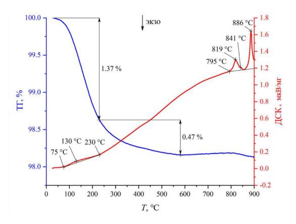
Рисунок 52. Данные дифференциальной сканирующей калориметрии (ДСК) и термогравиметрии (ТГ), полученные при нагревании образца 5.10.
