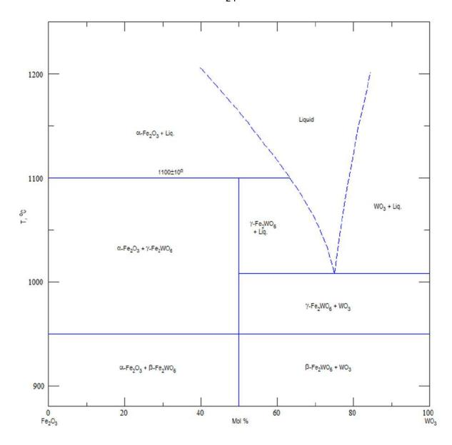
Рисунок 4. Фазовая диаграмма системы Fe<sub>2</sub>O<sub>3</sub> – WO<sub>3</sub> по данным работы [173].
