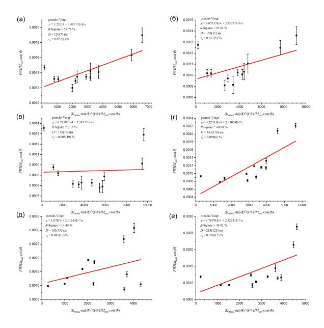
Рисунок 13. Графики «Вильямсона-Холла» для образцов серии I, синтезированных при различных значениях pH суспензии аморфного предшественника (а (pH = 2), б (pH = 3), в (pH = 4), г (pH = 5), д (pH = 6), е (pH = 7)). Расчёт производился по группе рефлексов: 111, 222, 400, 511, 440, 531, 622, 444, 711, 731, 1022 и 1062.
