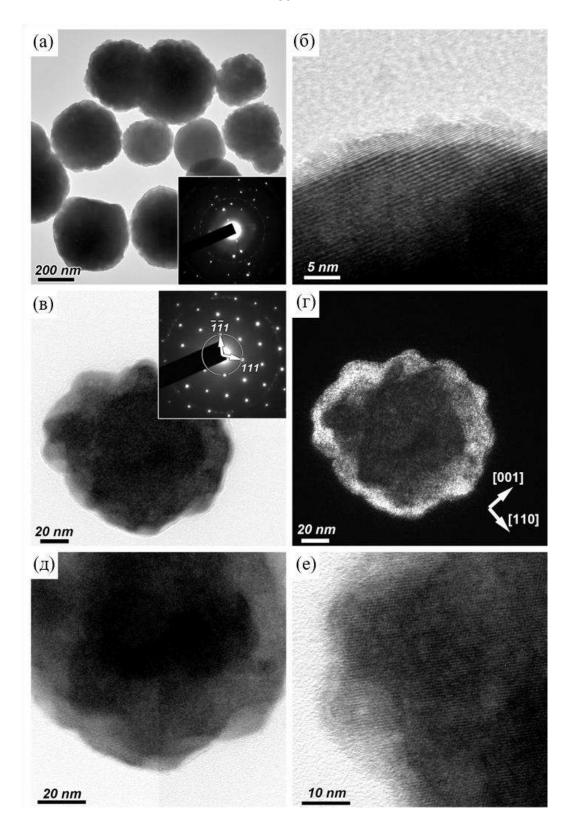
Рисунок 35. (микрореактор) Данные просвечивающей электронной микроскопии образца, синтезированного при продолжительности изотермической выдержки ( $\tau$ ) 24 часа.
