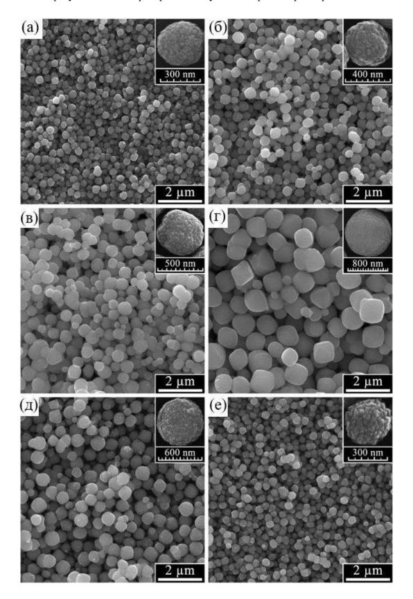
Рисунок 14. Микрофотографии образцов серии I, полученных при различных значениях рH суспензии аморфного предшественника (pH = 2 (a), 3 (б), 4 (в), 5 (г), 6 (д) и 7 (е)).
