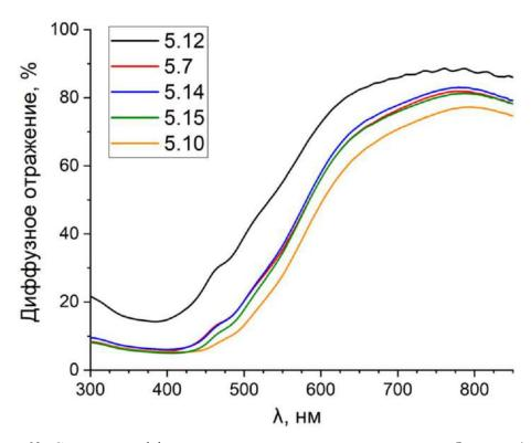
Рисунок 60. Спектры диффузного отражения синтезированных образцов (образцы серии V).
