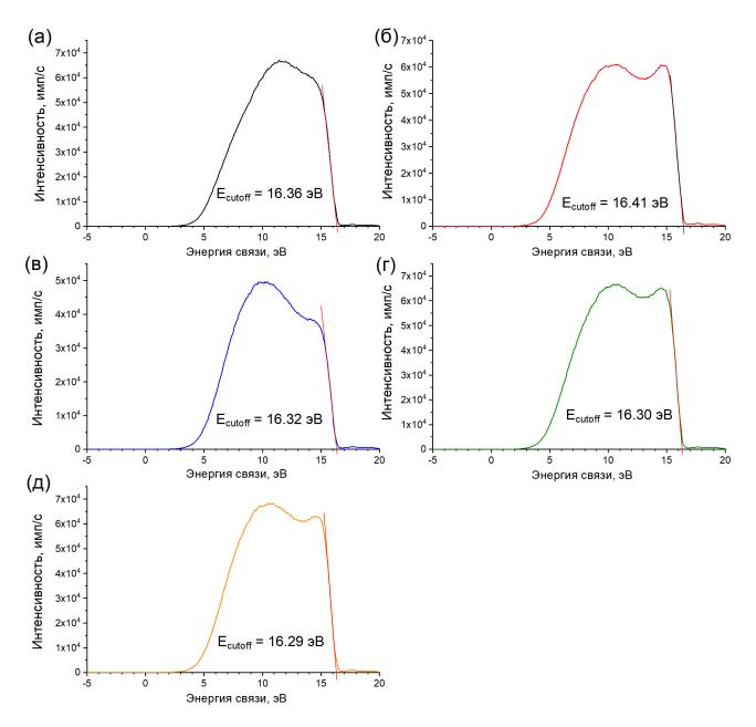
Рисунок 58. Графическое определение энергии отсечки вторичных электронов ( $E_{\text{cutoff}}$ ) по данным ультрафиолетовой фотоэлектронной спектроскопии (образцы серии V: а (5.12), б (5.7), в (5.14), г (5.15), д (5.10)).
