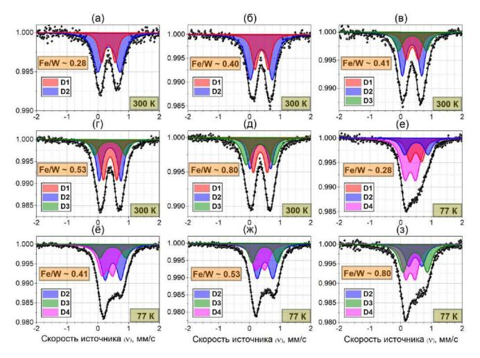
Рисунок 39. Мёссбауэровские спектры образцов серии V (300 К: а (5.12), б (5.7), в (5.14), г (5.15), д (5.10); 77 К: (е (5.12), ё (5.14), ж (5.15), з (5.10)).
