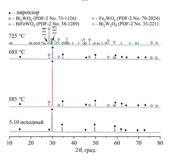
Рисунок 53. Порошковые рентгеновские дифрактограммы (Cu- $K_{\alpha}$  излучение) образцов, полученных отжигом образца 5.10 до различных температур – 585 °C, 685 °C и 725 °C с закалкой до комнатной температуры. Записи дифрактограмм проведены при комнатной температуре.
