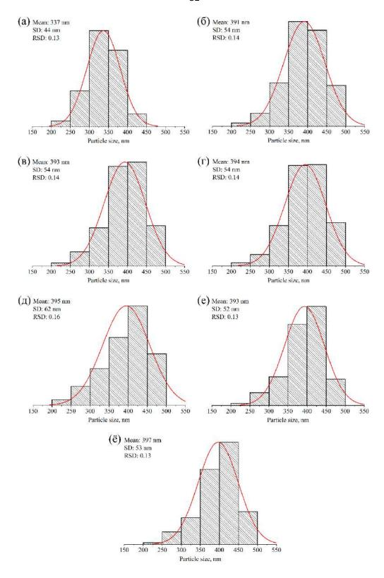
Рисунок 32. (микрореактор) Гистограммы и соответствующие функции объёмного нормального распределения частиц соединений со структурой пирохлора по размерам и параметры нормального распределения: средний размер (Mean), стандартное отклонение (SD) и относительное стандартное отклонение (RSD) для образцов серии IV, синтезированных при различной продолжительности изотермической выдержки ( $\tau$ ) (0.5 (a), 1 (б), 1.5 (в), 2 (г), 3 (д), 6 (е), 24 (ё) ч).
