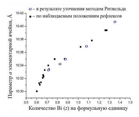
Рисунок 50. Зависимость параметра a кубической элементарной ячейки соединений со структурой пирохлора от количества висмута на формульную единицу (z) соединений (общая формула – ( $\mathrm{Bi}_z\square_{2-z}$ )( $\mathrm{Fe}_{2-v}\mathrm{W}_v$ )O<sub>6</sub>O $^{\circ}_{\delta}$ ).
