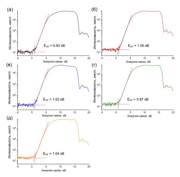
Рисунок 59. Графическое определение положения максимума валентной зоны относительно уровня Ферми ( $E_{VF}$ ) по данным ультрафиолетовой фотоэлектронной спектроскопии (образцы серии V: а (5.12), б (5.7), в (5.14), г (5.15), д (5.10)).
