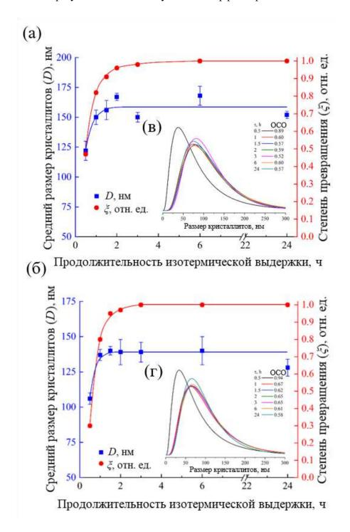
Рисунок 28. (а — микрореактор, б — капельное смешение) Зависимости степени превращения аморфной фазы в кристаллическую фазу пирохлора ( $\xi$ ) и среднего размера кристаллитов фазы пирохлора (D) от продолжительности изотермической выдержки ( $\tau$ ); (в — микрореактор, г — капельное смешение) функции логнормального объёмного распределения кристаллитов по размерам по рефлексу 222 в зависимости от продолжительности изотермической выдержки ( $\tau$ ) (ОСО — относительное стандартное отклонение).
