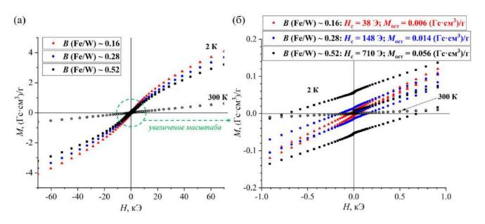
Рисунок 66. (а) Зависимости DC-намагниченности от величины приложенного поля (M(H)) при 300 К (только для образца 5.10: B (Fe/W) ~ 0.52) и 2 К (для образцов 5.14, 5.15 и 5.10) и (б) то же самое, но в увеличенном масштабе. Атомные соотношения Fe/W взяты из Таблицы 18 (однофазные образцы серии V).
