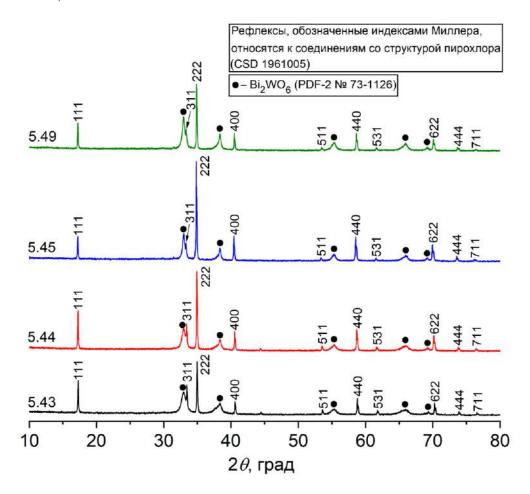
Рисунок 45. Рентгеновские дифрактограммы (Со- $K_{\alpha}$  излучение) образцов 5.43 − 5.45 и 5.49 серии V, отличающихся химическим составом и содержащих, кроме фазы пирохлора (избранные рефлексы отмечены индексами Миллера), заметные количества фазы  $Bi_2WO_6$  (PDF-2 № 73-1126).
