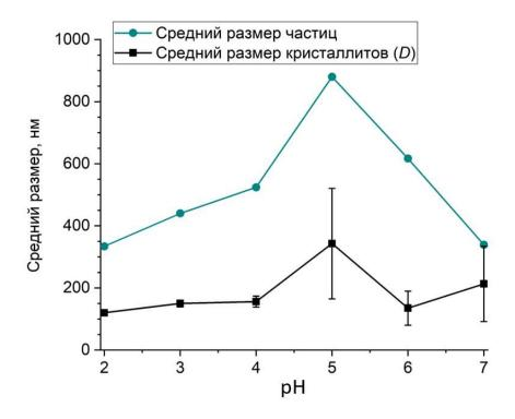
Рисунок 16. Зависимости средних размеров частиц и кристаллитов соединений со структурой пирохлора от рН суспензии аморфного предшественника (образцы серии I) (*прим*. средний размер кристаллитов рассчитан методом «Вильямсона-Холла» по группе рефлексов: 111, 222, 400, 511, 440, 531, 622, 444, 711, 731, 1022 и 1062, см. Рисунок 12 а).
