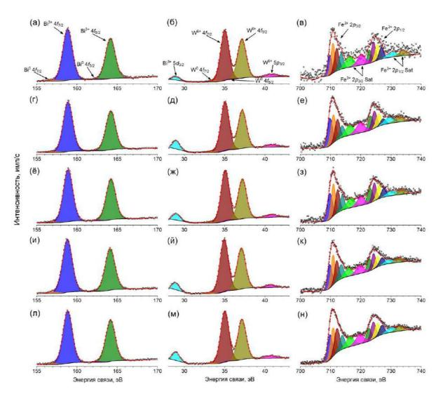
Рисунок 55. Детальные рентгеновские фотоэлектронные спектры (кроме Bi4d- и W4d- электронных уровней) и графические результаты деконволюции наблюдаемых пиков с помощью функции Pseudo-Voight (образцы серии V: а, б, в (5.12); г, д, е (5.7); ё, ж, з (5.14); и, й, к (5.15); л, м, н (5.10)).
