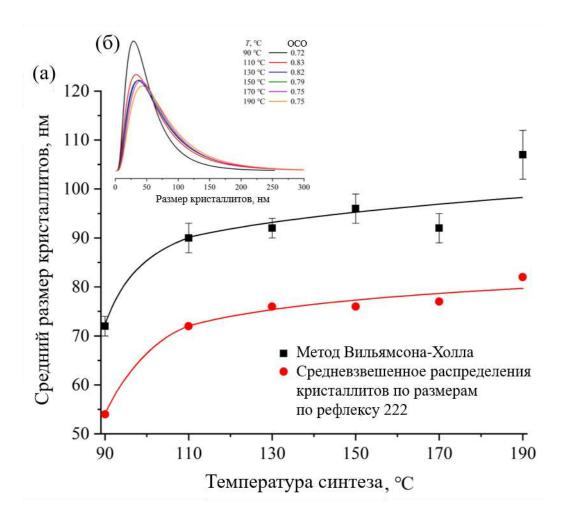
Рисунок 19. (a) Зависимости среднего размера кристаллитов соединений со структурой пирохлора от температуры синтеза и (б) функции логнормального объёмного распределения кристаллитов по размерам по рефлексу 222 в зависимости от температуры синтеза.
