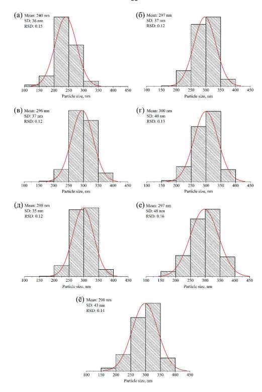
Рисунок 33. (капельное смешение) Гистограммы и соответствующие функции объёмного нормального распределения частиц соединений со структурой пирохлора по размерам и параметры нормального распределения: средний размер (Mean), стандартное отклонение (SD) и относительное стандартное отклонение (RSD) для образцов серии IV, синтезированных при различной продолжительности изотермической выдержки ( $\tau$ ) (0.5 (a), 1 (б), 1.5 (в), 2 (г), 3 (д), 6 (е), 24 (ё) ч).
