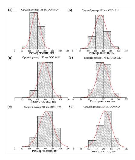
Рисунок 22. Гистограммы и соответствующие функции объёмного нормального распределения частиц соединений со структурой пирохлора по размерам и параметры нормального распределения: средний размер и ОСО (относительное стандартное отклонение), для образцов серии II, полученных при различных температурах синтеза (а (90 °C), б (110 °C), в (130 °C), (г (150 °C), д (170 °C), е (190 °C)).
