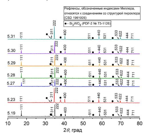
Рисунок 43. Рентгеновские дифрактограммы (Со- $K_{\alpha}$  излучение) образцов 5.19, 5.23 и 5.27 – 5.31 серии V, отличающихся химическим составом и содержащих, кроме фазы пирохлора (избранные рефлексы отмечены индексами Миллера), заметные количества фазы  $Bi_2WO_6$  (PDF-2 № 73-1126).
