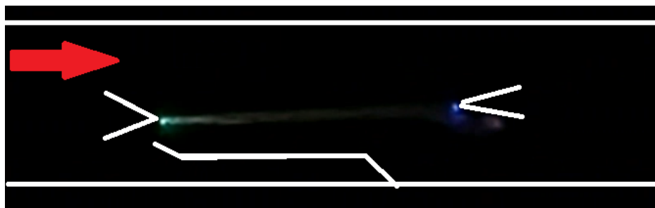
Рис.5.6. Кадр из видео продольного разряда (480 к/с и экспозиция 2 мс). Дополнительно затемнено светофильтром НС-11. Поток слева направо. Ток 1 А. Латунный катод. Белыми линиями отмечено расположение электродов.
