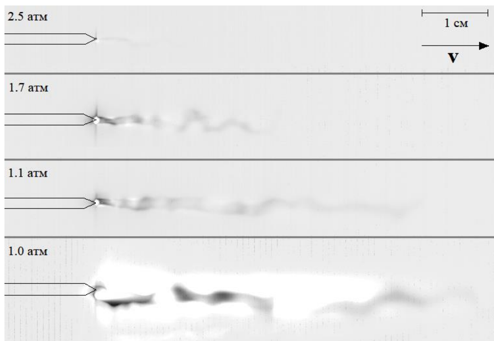
Рис. 4.1. Сборка кадров видеосъемки СВЧ разряда при различных давлениях в потоке p_{flow} . Экспозиция 2 мкс.
