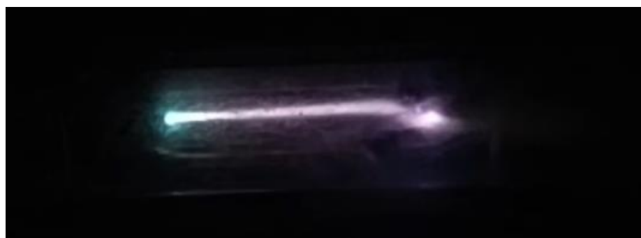
Рис.5.7. Кадр из видео продольного разряда (480 к/с и экспозиция 2 мс). Дополнительно затемнено светофильтром НС-10 (более слабый). Поток слева направо. Ток 1 А. Латунный катод.
