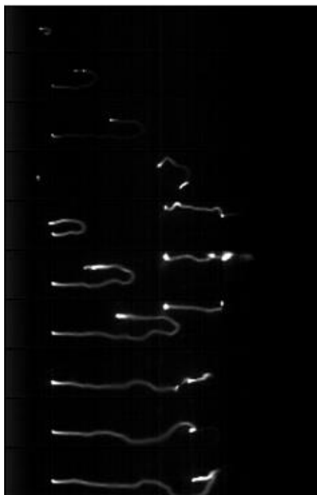
Рис.5.9. Серия кадров высокоскоростной съемки (15000 к/с, 2 мкс экспозиция) продольного разряда при токе 3 А, давлении 2 атм. Анод первый. Поток слева направо.
