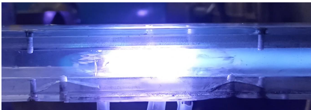
Рис. 5.18. Фото воспламененного продольным разрядом пропан-воздушного потока, снятое на телефон (экспозиция 33 мс). Поток слева направо. Ток 1 А. Вольфрамовый катод. Давление воздуха 2 атм и давление пропана 3 атм.
