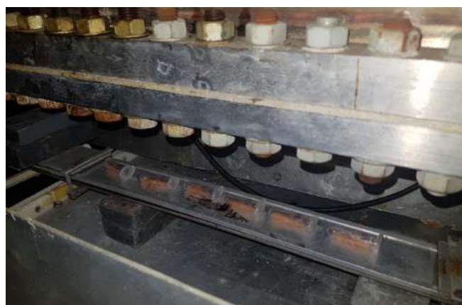
Рисунок 2.3 — Фотография и схема облучения биологических объектов на ускорителе электронов УЭЛР-1-25-T-001.
