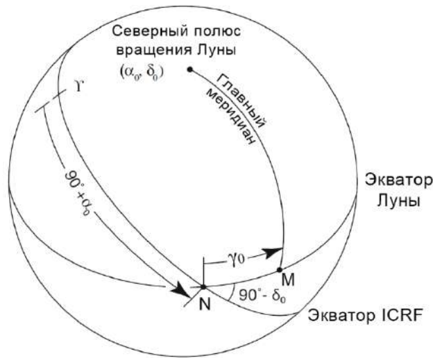
Рисунок 1.1 — Графическое представление перехода между инерциальной геоэкваatoriальной СК во вращающуюся систему относительно экватора Луны
