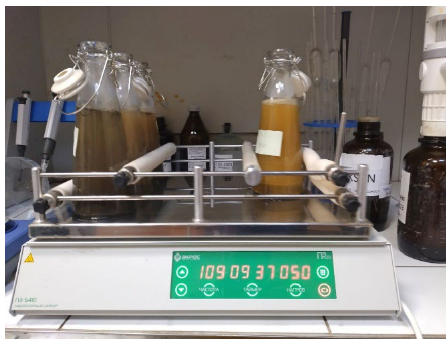
Рисунок 25. Процесс приготовления водной вытяжки на аппарате для встряхивания жидкости «ПЭ-6410» (фото — Садов Сергей)
