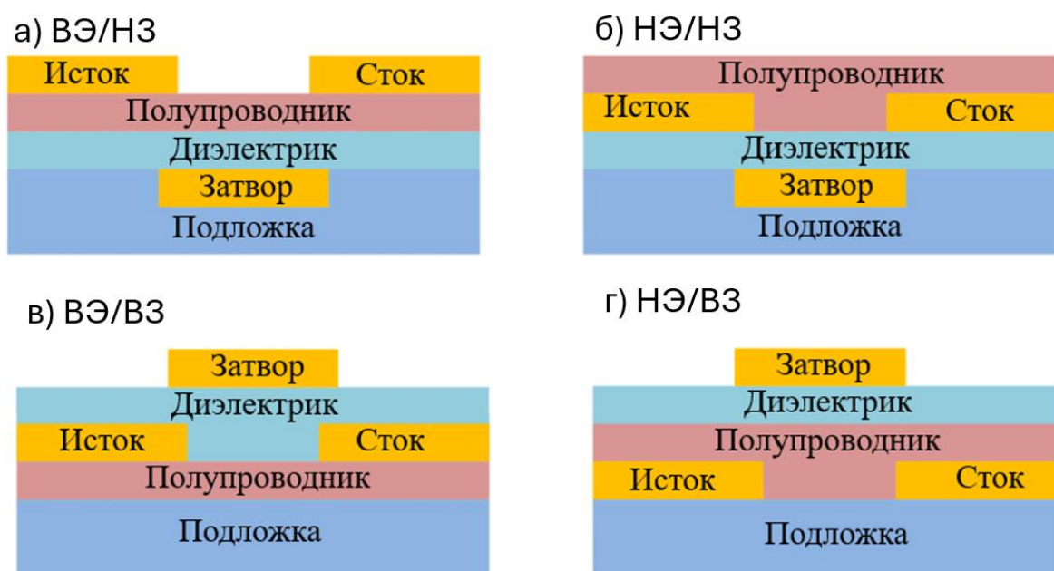
Рисунок 1.5. Различные варианты геометрии ОПТ: а) верхние электроды/нижний затвор, б) нижние электроды/нижний затвор, в) верхние электроды/верхний затвор и г) нижние электроды/верхний затвор.
