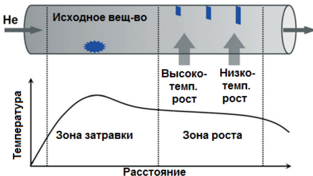
Рисунок 1.11. Схематическое изображение установки для роста органических кристаллов методом паровозного физического транспорта 100 .
