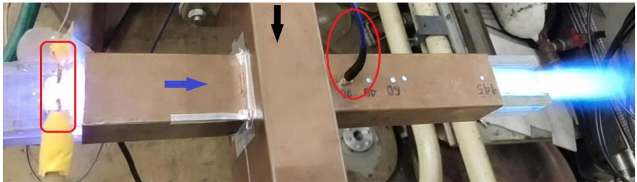
Рисунок 10. Фото воспламененного с помощью КР пропан-воздушного потока. Черная стрелка вниз – направление падающей СВЧ волны, синяя стрелка вправо – направление потока. Красным прямоугольником выделена вставка с электродами. Красным эллипсом выделено диагностическое оптоволокно. Условия эксперимента:  $i=1.2$  А,  $p_0=2$  атм,  $p_{prop}=4$  атм, мощность СВЧ 5 кВт.
