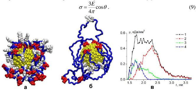
Рис. 6. Полипептиды ( $ADA_2RA$ )<sub>50</sub> (а) и  $A_8(A_8D_2A_{16}R_2A_8)_8A_8$  (б) на поверхности поляризованной в вертикальном направлении золотой наночастицы, а также радиальные зависимости средней плотности атомов полипептида ( $A_4R_2A_8D_2A_4$ )<sub>20</sub> на поверхности поляризованной наночастицы (в, 1 – и по всем атомам полипептида, 2, 3 и 4 - по аминокислотным остаткам Ala, Arg и Asp).
