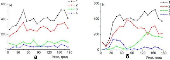
Рис. 7. Зависимости средних угловых распределений атомов полипептида  $(A_4R_2A_8D_2A_4)_{20}$  на поверхности неполяризованной (а) и поляризованной (б) золотой наночастицы (1- по всем атомам полипептида; 2, 3 и 4 - по типам аминокислотных остатков Ala, Arg и Asp, отрицательно заряженному полюсу соответствует угол 180 градусов, экваториальной области - угол 90 градусов, а положительно заряженному полюсу – угол 0 градусов).
