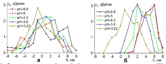
Рис. 20. Распределения средней линейной плотности атомов полипептида 100 звеньев глутаминовой кислоты при различных значениях рН вдоль большой оси вытянутого золотого наносфероида, поляризованного с дипольным моментом  $p_{0.25}$  (a) и  $p_{1.0}$  (б).
