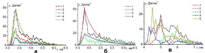
Рис. 4. Радиальные зависимости средней плотности атомов полипептида  $(A_2D_2A_3R_2A)_{10}$  на нейтральной наночастице без молекул эозина (а, 1 — по всем атомам полипептида, 2, 3 и 4 — по Ala, Arg, Asp, 5 —аппроксимирующая кривая) и с молекулами эозина (б, по атомам полипептида (1) и эозина (3), 2 и 4 —аппроксимирующие кривые, а также на поверхности положительно заряженной наночастицы (в, 1 —по всем атомам полипептида; 2, 3 и 4 - по Ala, Arg и Asp, 5 — по атомам эозина).
