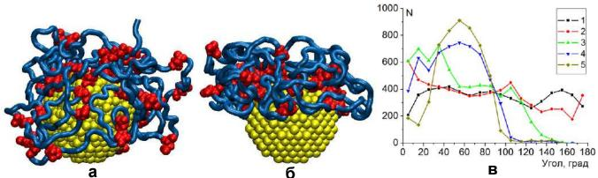
а Рис. 10. Конформации полипептида ( $A_5DA_4$ )<sub>40</sub> на поверхности поляризованной с дипольным моментом  $p_{0.25}$  (а) и  $p_{1.0}$  (б) наночастицы. Средние угловые распределения атомов данного полипептида (в) на поверхности поляризованной наночастицы нормированные на экваториальную область (1 – неполяризованная наночастица,  $2 - p_{0.125}$ ,  $3 - p_{0.25}$ ,  $4 - p_{0.5}$ ,  $5 - p_{1.0}$ ).
