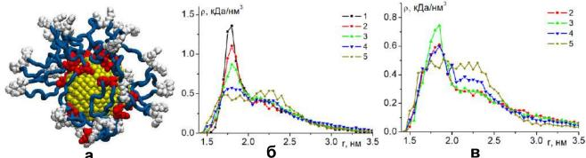
Рис. 9. Конформация полипептида ( $A_4R_2A_8D_2A_4$ )<sub>20</sub> после МД-моделирования на поверхности наночастицы при  $Q_{0.15}$  и  $p_{0.25}$  (а). Радиальные зависимости средней плотности атомов полипептида при  $Q_{0.05}$  (б) и  $Q_{0.15}$  (в) (1 – стартовое распределение на нейтральной наночастице,  $2-p_{0.125}$ , 3 - при  $p_{0.25}$ , 4 - при  $p_{0.5}$ , 5 -  $p_{1.0}$ ).
