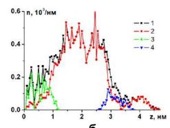
Рис. 2. Конформация полипептида  $A_{11}D_2A_{23}R_2A_{22}CD_2A_{23}R_2A_{12}$  на золотой подложке при  $\sigma_{-0.15}$  (а), а также «высотная» зависимость (б) средней концентрации атомов полипептида  $(A_4RA_9DA_5)_2A_4RCA_8DA_5(A_4RA_9DA_5)_2$  при  $\sigma_{-0.15}$  (1 — по всем атомам полипептида; 2, 3, 4 —по типам аминокислотных остатков Ala, Arg и Asp).
