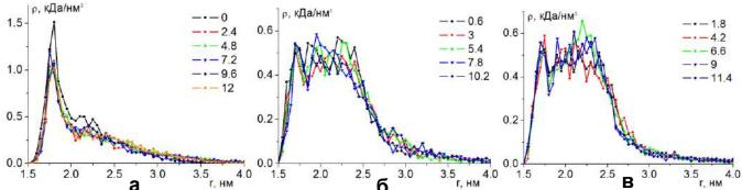
Рис. 24. Радиальные распределения плотности атомов полипептида  $(A_4R_2A_8D_2A_4)_{20}$  на поверхности золотой наночастицы по окончанию МД-моделирования при температуре 900 К на временных отрезках (обозначены цифрами в нс) в случаях, когда наночастица не поляризована (а), поляризована с дипольным моментом  $+0.97p_{np\_max}$  (б) и  $-0.97p_{np\_max}$  (в).
