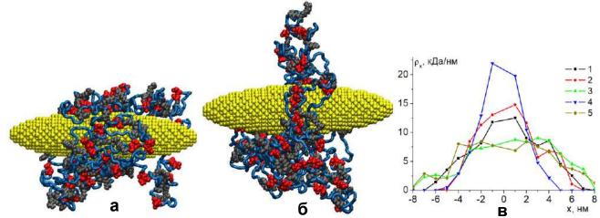
Рис. 27. Конформации полипептида ( $A_4R_2A_8D_2A_4$ )<sub>49</sub> по окончанию МД-моделирования с периодическим изменением полярности наносфероида вдоль большой оси при температуре 300 К с пиковым значением дипольного момента  $p_{1\_max}$  (а) и  $p_{2\_max}$  (б). Распределения линейной плотности атомов полипептида (в) вдоль большой оси наносфероида (1 - стартовая конформация, 2 и 3 при  $p_{1\_max}$ , 4 и 5 при  $p_{2\_max}$ ) при температуре 300 К (2 и 4) и 900 К (3 и 5).
