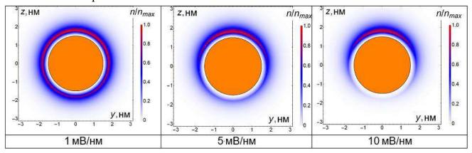
Рис. 11. Асимметричное перераспределение плотности звеньев опушечного слоя на поверхности поляризованной золотой наночастицы при различных значениях напряженности локального электрического поля.
