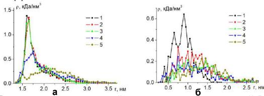
Рис. 17. Радиальные зависимости средней плотности атомов полипептида ( $A_2DA_4RA_2$ )<sub>60</sub> в центральной (а) и в полярной (б) областях наносфероида (1 - на нейтральной поверхности, 2 и 3 - на поверхности поляризованной с дипольным моментом  $p_{0.5}$  и  $p_{1.0}$ , а 4 и 5 - заряженной с полным зарядом  $Q_{0.5}$  и  $Q_{1.0}$  наночастицы).
