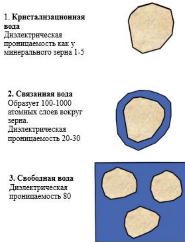
Рисунок 13. Виды воды в горной породе и ее ДП (Owenier et al., 2016)
