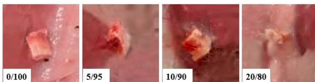
Рисунок 39. Результаты испытаний in vivo для образцов керамических материалов на основе ПФК, обожжённых при температуре 1000 °С
