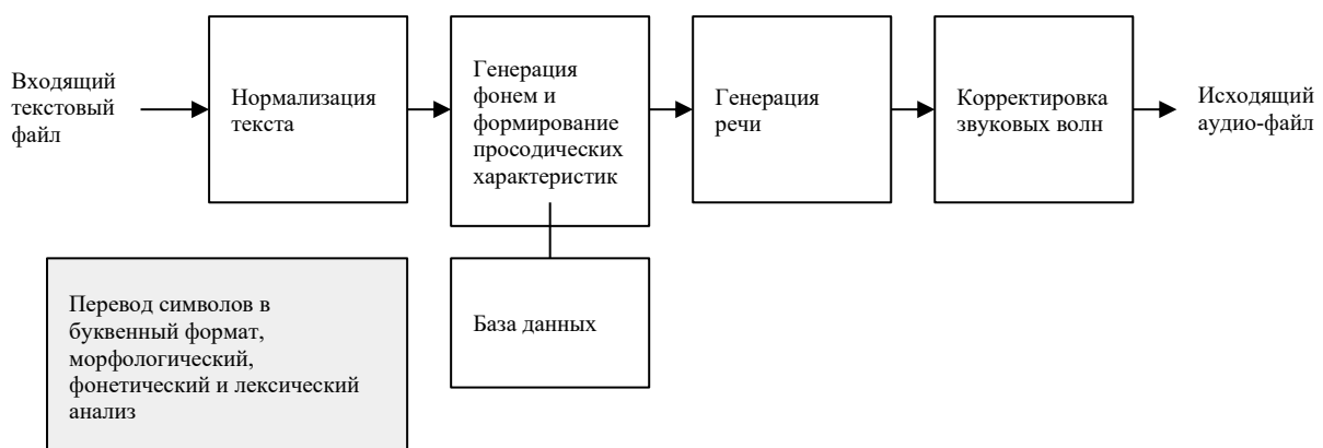
Рисунок 6. Алгоритм, лежащий в основе технологии синтеза речи
