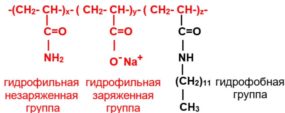
Рисунок 2.2. Химическая структура ГМ терполимеров акриламида, акрилата натрия и н-додецилакриламида.
