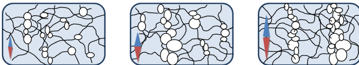
Рисунок 5.20. Схематическое изображение изменения структуры нанокомпозитной сетки червеобразных мицелл ПАВ и частиц магнетита при возрастании напряженности однородного магнитного поля, соответствующей областям I (короткие агрегаты), II (длинные цепочечные структуры) и III (длинные толстые колончатые структуры), изображенным на рис.5.19а. Стрелки указывают направление силовых линий магнитного поля.
