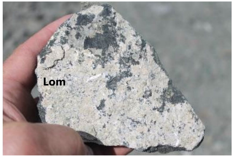
Рисунок 5.3.7. Метагаббронорит-долериты пренит-пумпеллиитовой фации брекчированы и пересечены сетью прожилков ломонтита. Слева - ломонтит окрашен тонко дисперсным лепидокрокитом, центр Лозовского-Ферсмановского интрузива. Справа – ломонтит белого цвета, приконтактовая часть того же интрузива. Фото Э.М. Спиридонова.
