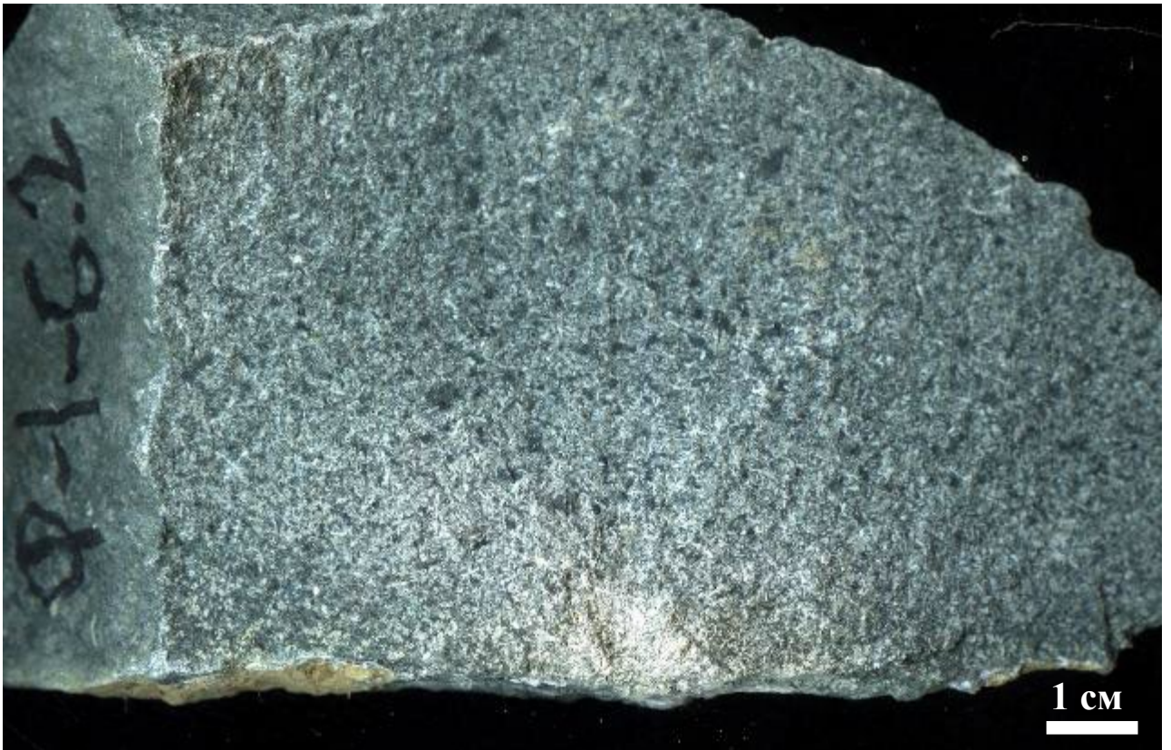
Рисунок 4.1.32. Промежуточная часть Лозовского-Ферсмановского интрузива. Среднезернистые габбронорит-долериты с реликтами вкрапленников оливина и небольшими идиоморфными табличками битовнита. 122×73 мм. Колл. и фото Э.М. Спиридонова.
