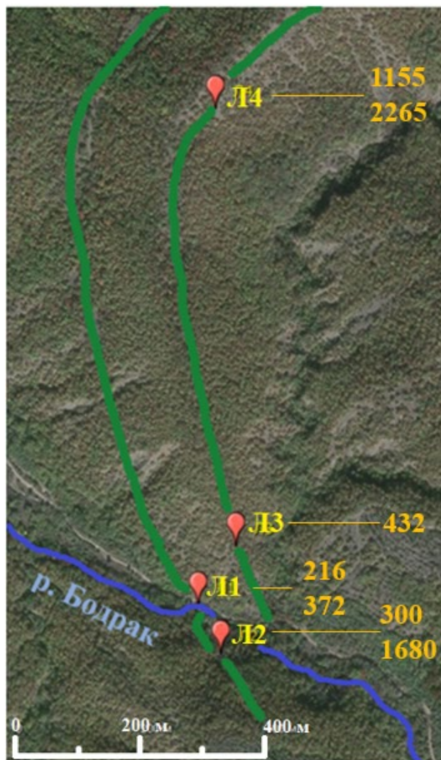
Рисунок 5.4.1. Схема пунктов каппаметрии (Л1 – Л4) на силлообразном интрузиве Лебединский в верховьях реки Бодрак. Цифрами указана магнитная восприимчивость ( \times 10^{-5} ед. СИ) максимального количества измерений.
