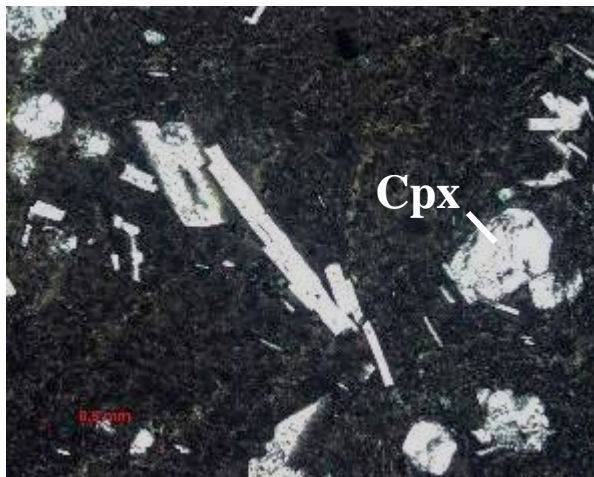
Рисунок 4.1.35. Фрагмент образца рис. 4.1.34. Эффузивоподобные базиты эндоконтакта Лозовского-Ферсмановского интрузива. В тонкозернистой матрице – вкрапленники Са плагиоклаза, округлого оливина (в левой и нижней части шлифа) (замещен серпентином) и авгита (Срх). В проходящем свете, слева при 1 николе, справа - николи X.
