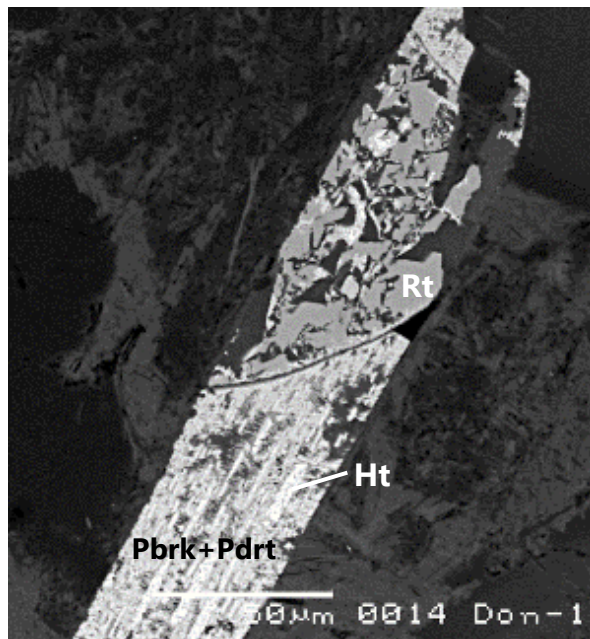
Рисунок. 5.2.19. Двуминеральная псевдоморфоза по магматическому ильмениту сростания псевдобрукита и псевдорутила. Их замещают рутил (гладкие серые участки, табл. 5.2.7, ан. 19, 20) и гематит (белые пластины), в отраженных электронах. Метаморфизованные оливинные габбронорит-долериты интрузива Донузоран.
