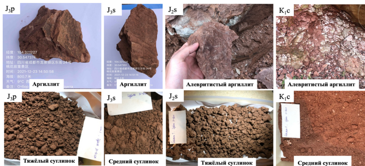
Рисунок 4. Морфологические особенности образцов исходных горных пород и продуктов их выветривания, отобранных из различных стратиграфических подразделений (Классификационное наименование красноцветным грунтам дано в соответствии с китайским национальным стандартом GB/T 8845–2001 «Методика анализа гранулометрического состава почвы») (фото-Пэн Ичжоу)
