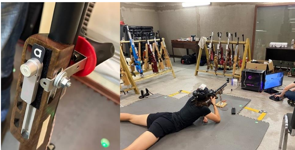
Рисунок 8 – Расположение датчика Antilatency на винтовке (слева) и расположение испытуемого на резиновом покрытии Antilatency (справа)
