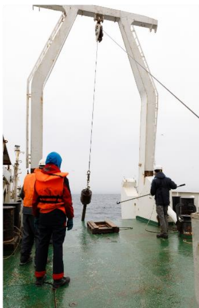
Рисунок 10. Пробоотбор образцов донных отложений гравитационной трубкой, НИС «Академик Николай Страхов», Баренцево море, октябрь 2021г.
