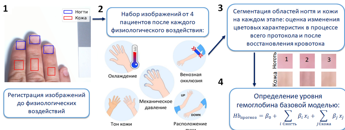
Рисунок 3. Схема протокола эксперимента: регистрация изображений ногтевого ложа и близлежащей кожи до и после физиологических воздействий, сегментация областей ногтевого ложа и кожи и расчёт определяемого уровня Hgb базовой регрессионной моделью
