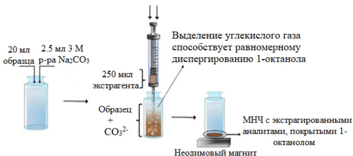
Рис. 3. Схема проведения ДЖЖМЭ- \text{CO}_2 , представленная в первой работе посвященной данному методу [36].
