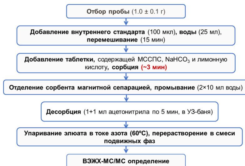
Рис. 23. Схема пробоподготовки мёда методом МТФЭ-СО 2 .
