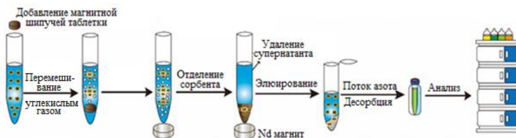
Рис. 5. Схема осуществления МТФЭ- \text{CO}_2 [128].
