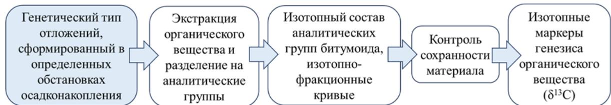
Рис. 4. Схема методического подхода использования изотопных маркеров для анализа трансгрессивных-регрессивной цикличности строения разреза.
