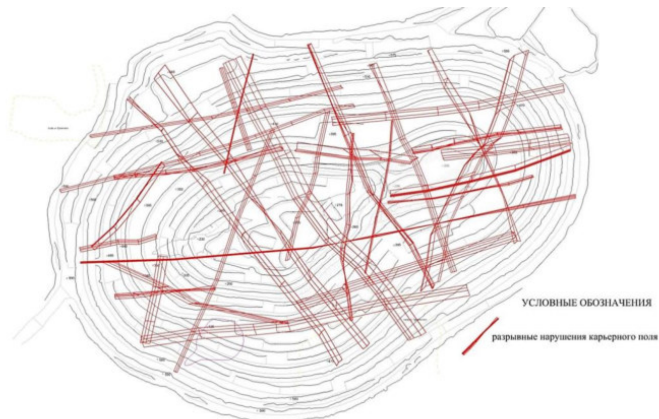
Рис. 4.12 Тектонические нарушения в пределах карьерного поля трубки «Юбилейная» (по материалам Айхальского ГОКа и съемки ИЗК СО РАН) [406]
