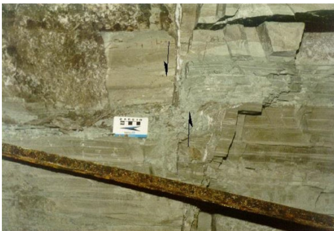
Рис. 4.17 Разрывное нарушение сбросового типа, зафиксированное в подземных горных выработках [406]
