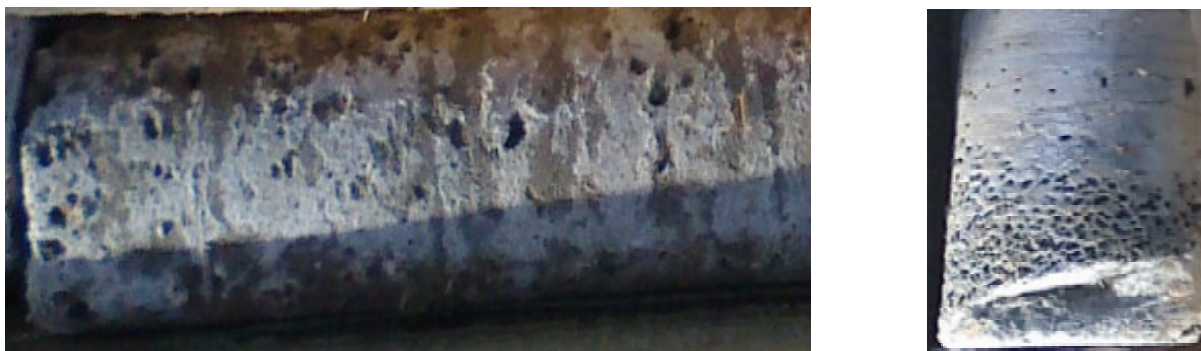
Рис. 5.23. Коллекторы ичерской свиты в центральной части (по скважине 13') (фото А. М. Янникова)
