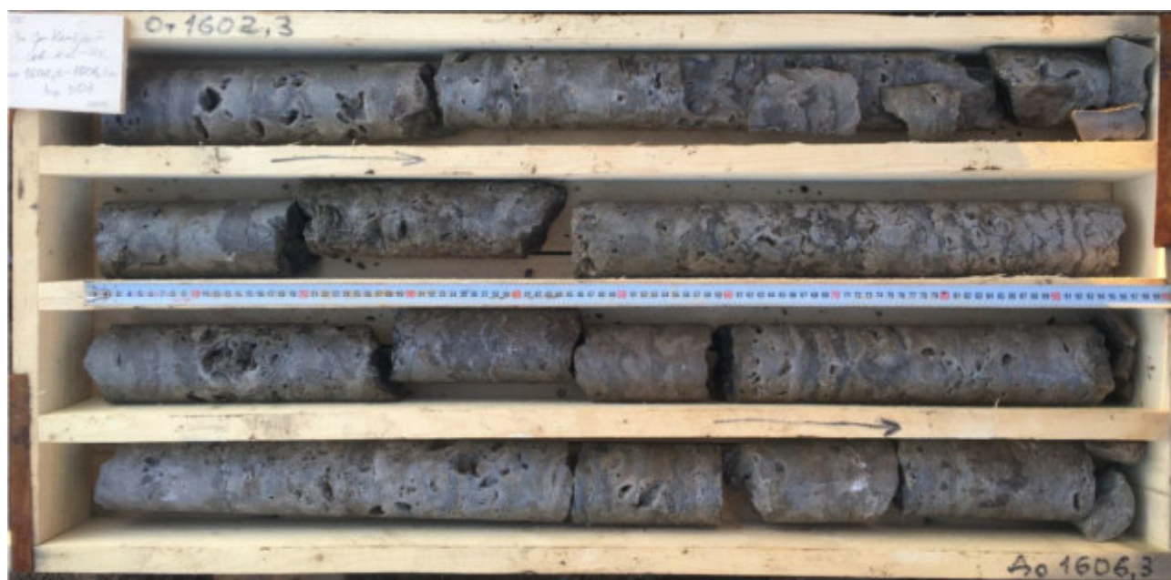
Рис. 5.16. Интервал известняков кавернозных (коллекторы нижекембрийского водоносного комплекса) [408]
