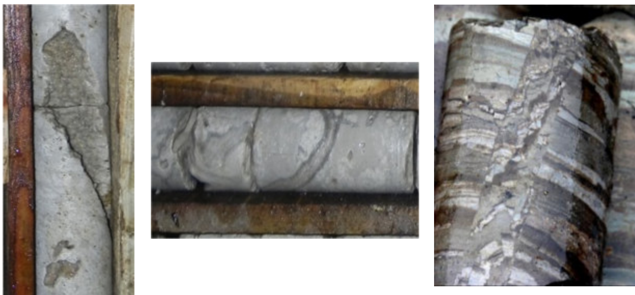
Рис. 4.10 Вмещающие породы в зоне тектонических нарушений (кern слева – открытые полости; образцы справа – трещины залечены) [408]
