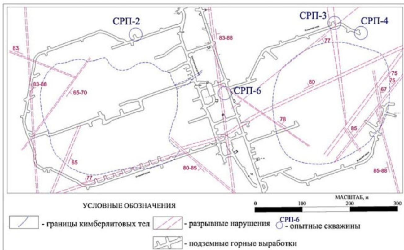
Рис. 4.8 Тектонические нарушения в пределах шахтного поля трубки «Удачная» [408]
