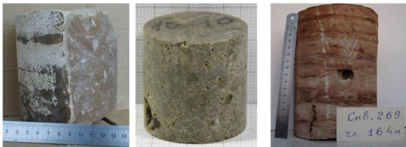
Рис. 5.9. Коллекторы криогенной толщи, формирующиеся в результате плавления жильных льдов (по [167] с дополнениями)
