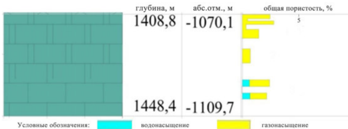
Рис. 2.17. Схема коллекторов эльгянского водоносного горизонта (в пределах трубки шахтного поля трубки Мир) [393]
