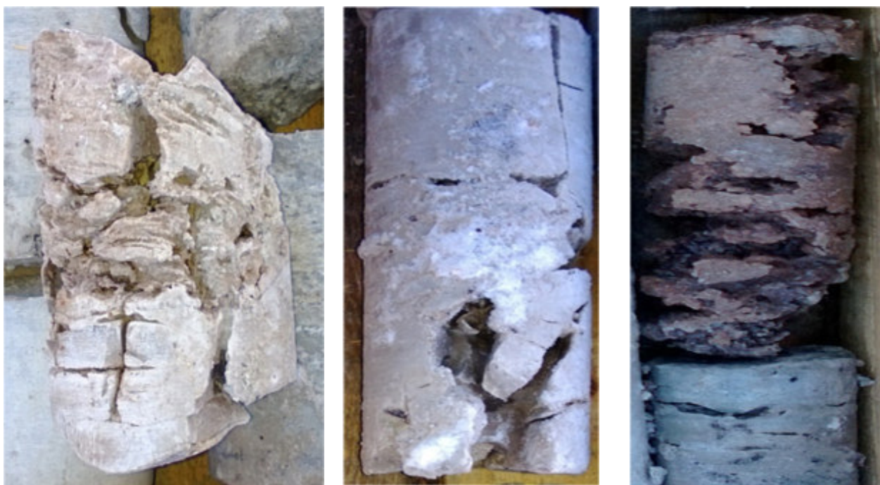
Рис. 5.22. Коллекторы ичерской свиты в северной части (по скважине 513") (фото А.М. Янникова)
