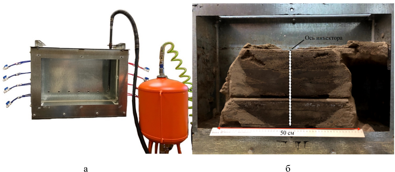
Рис. 7. Стендовая установка для моделирования инъекционного закрепления грунтов методом пропитки (а), закрепленный целик (б) песчаного грунта ( aQ_{III}^{II} ) (вид с фронтальной части)
