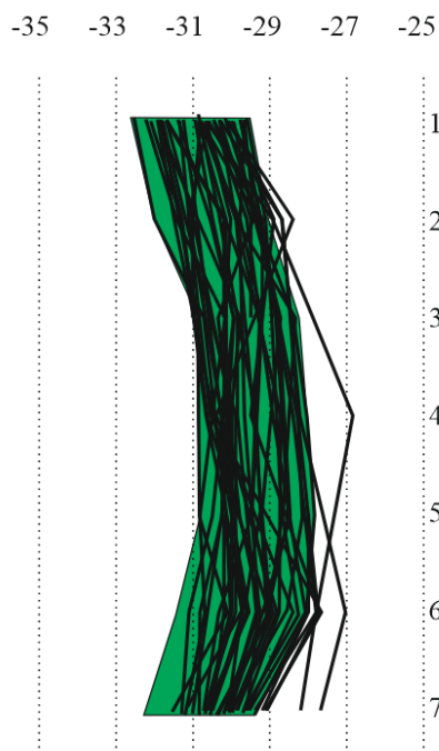
Рис. 48. Изотопно-фракционная кривая группы 5 (Рис. 41, Рис. 42, Рис. 43), выделенная в Западно-Сибирском бассейне. Условные обозначения см. Рис. 41. На графике черными линиями нанесены данные изотопного состава углерода фракций битумоидов трансгрессивного цикла верхнеюрской формации Хеккинген пачки Альге ( J_{3\ 0+km} ).
