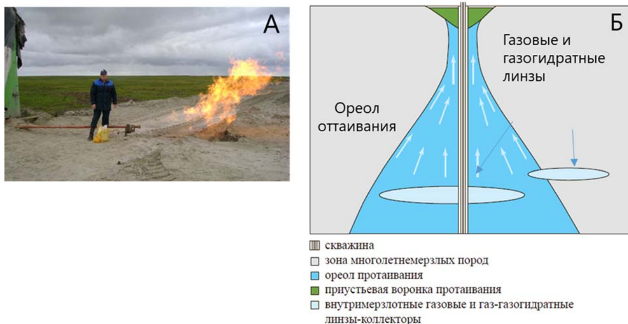
Рис. 66. А - Газопроявление из надсеноманского разреза (глубина забоя 430 м) при бурении разведочной скважины. Б - Схема формирования потока внутримерзлотного газа при оттаивании ММТ вокруг работающей скважины (Леонов С.А., 2010; Якушев В.С., 2015а).
