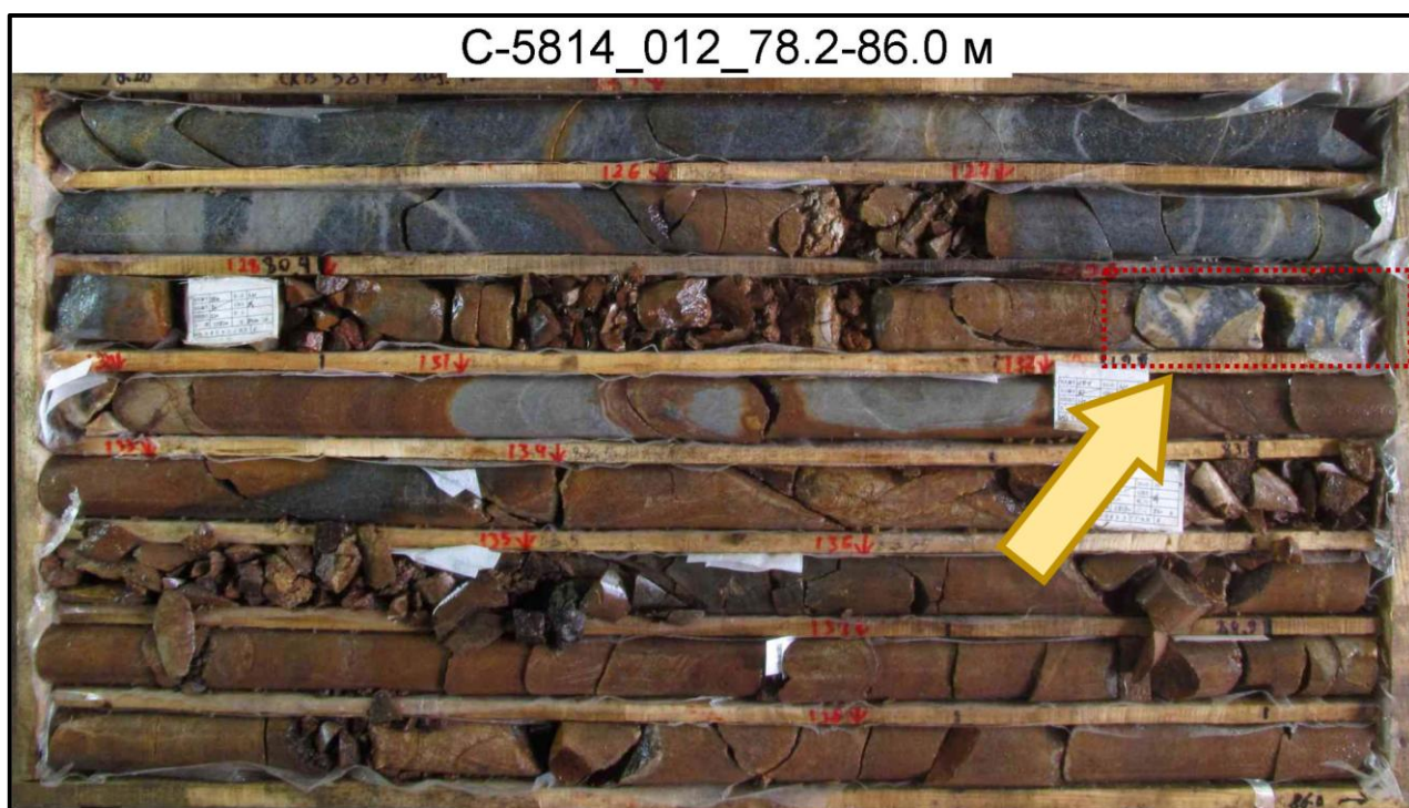
Рисунок 7 – Пересечение скважиной интервала с содержанием сурьмы >1\% , оказавшегося жилой с антимонитом, Сква. С-5814, гл. 81.0 м
